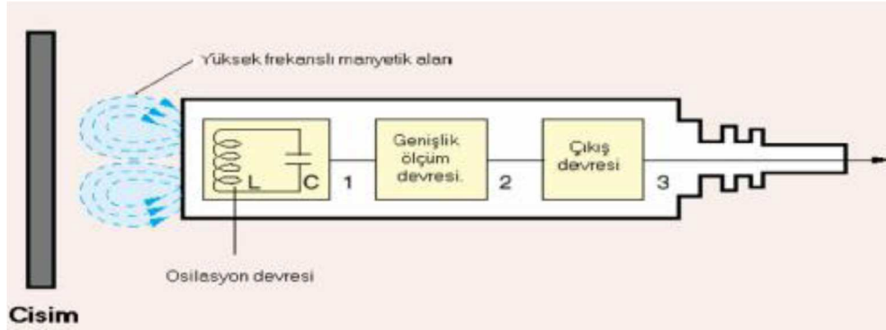
Şekil 2.15. Elektronik devreli manyetik algılayıcının iç yapısı
