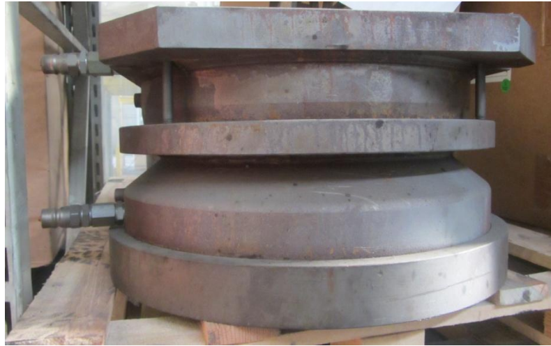
Şekil 3.6. 580±10 mm çapındaki roll tipi körüğü üretmek için uygun olan roll tipi vulkanizasyon kalıbının imalat görüntüsü
