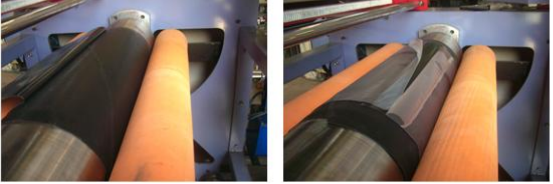
Şekil 3.10. Konfeksiyon Makinesinde kord bezi ve dış kauçuk sarım işlemi
