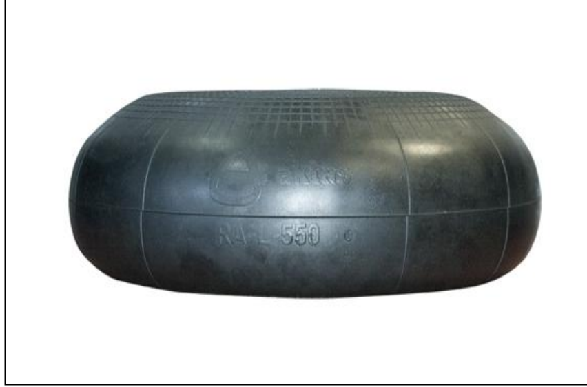
Şekil 4.1. Prototip olarak imal edilen 505 mm çapındaki roll tipi hava süspansiyon körüğü
