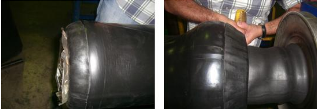
Şekil 3.11. Sarım işlemi tamamlanan körüğün vulkanizasyon öncesinde telleme işlemi
