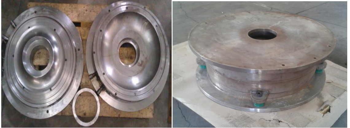
Şekil 3.4. 505±10 mm çapındaki roll tipi körüğü üretmek için uygun olan roll tipi vulkanizasyon kalıbının imalat görüntüsü
