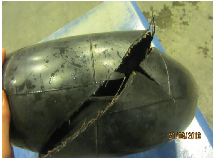
Şekil 4.3. A tipi körük patlama sonrasındaki körüğün hasar görünümü
