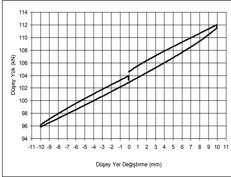
Şekil 4.7. Raylı taşıt körüğünün düşey yay katsayısının hesaplanmasında kullanılan düşey yük-düşey yer değiştirme grafiği
