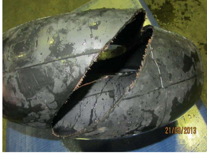
Şekil 4.4. B tipi körük patlama sonrasındaki körüğün hasar görünümü
