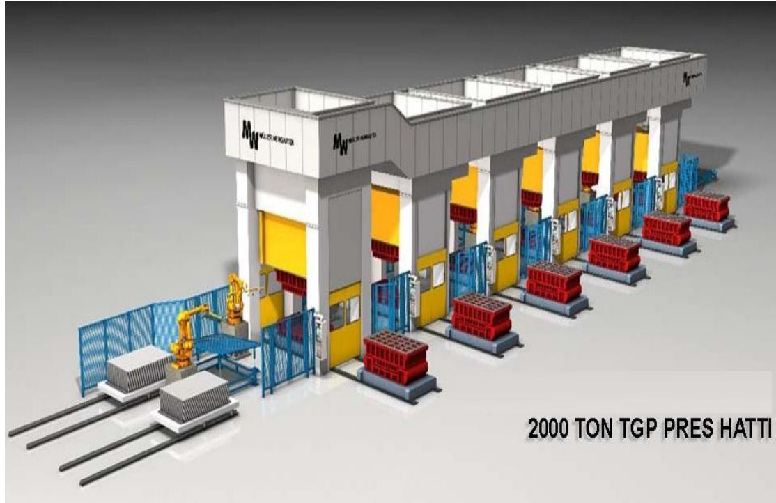
Şekil 3.9 Hat başı preslerde mobil tabla uygulaması
