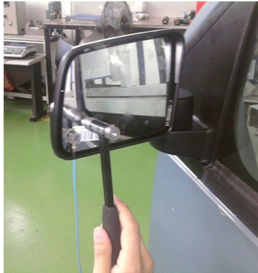
Şekil 3.27. Modal çekiç ile vuruş
