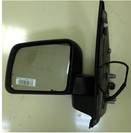
Şekil 3.5. Avrupa ülkeleri için üretilen konveks camlı ayna
