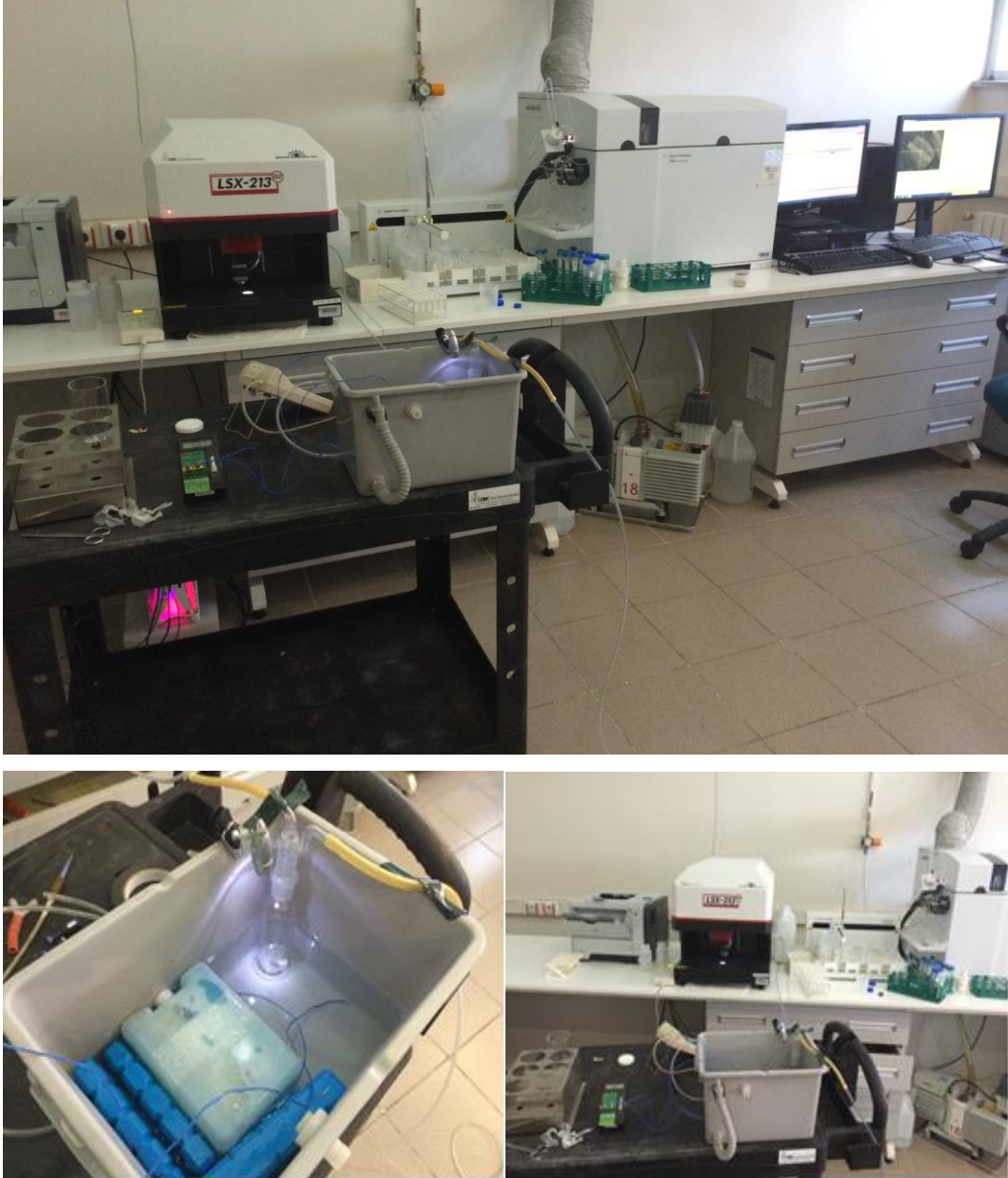
Şekil 4.19. LA-Çözgen Tuzak-GC-MS Yöntemi ile Kalitatif Tarama.
