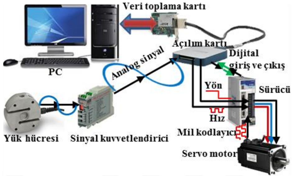
Şekil 3.5. Cihazın elektronik elemanları ve sinyal akışı
