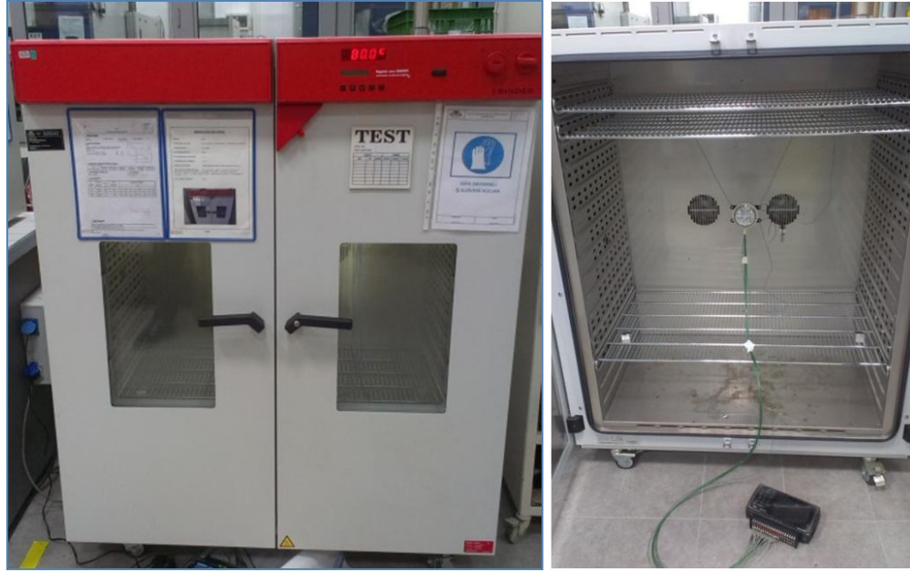
Şekil 3.59. DRL ürünün test edildiği sabit sıcaklık ortam sınır koşulunu sağlayan fırın(solda) ve test düzeneğinin görünümü (sağda)
