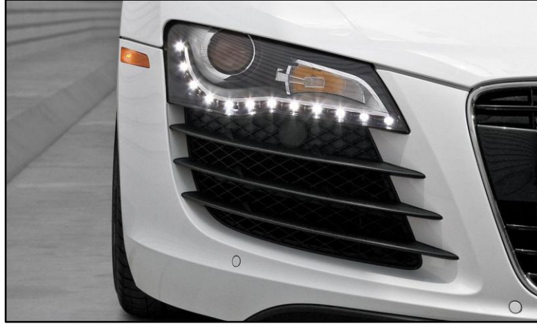
Şekil 1.24. AUDI R8 aracına ait LED içeren bir far görünümü (Anonim 2014d)
