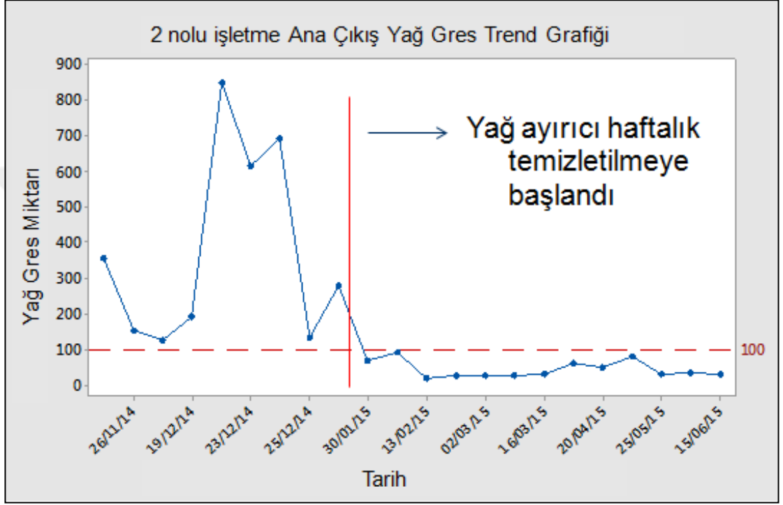
Şekil 5.6. 2 nolu işletme arıtma tesisi çıkışında yağ gres trend grafiği
