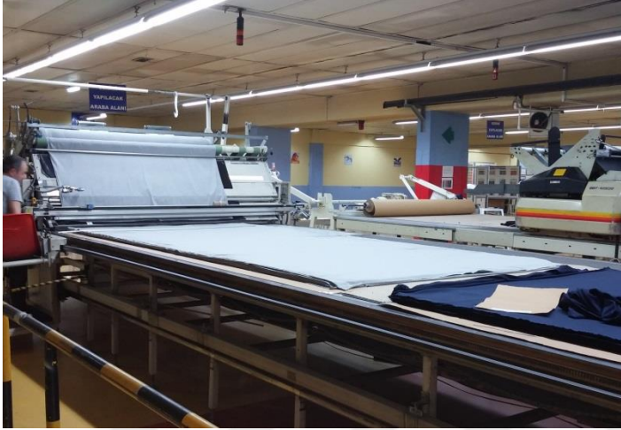
Şekil 2.6. Kesimhanede Serim Makinesiyle Yapılan Serim İşlemi (Yeşim Tekstil 2015)
