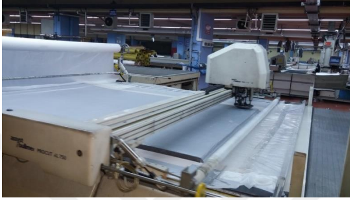
Şekil 2.9. Cutter ile Kesim İşlemi (Yeşim Tekstil 2015)
