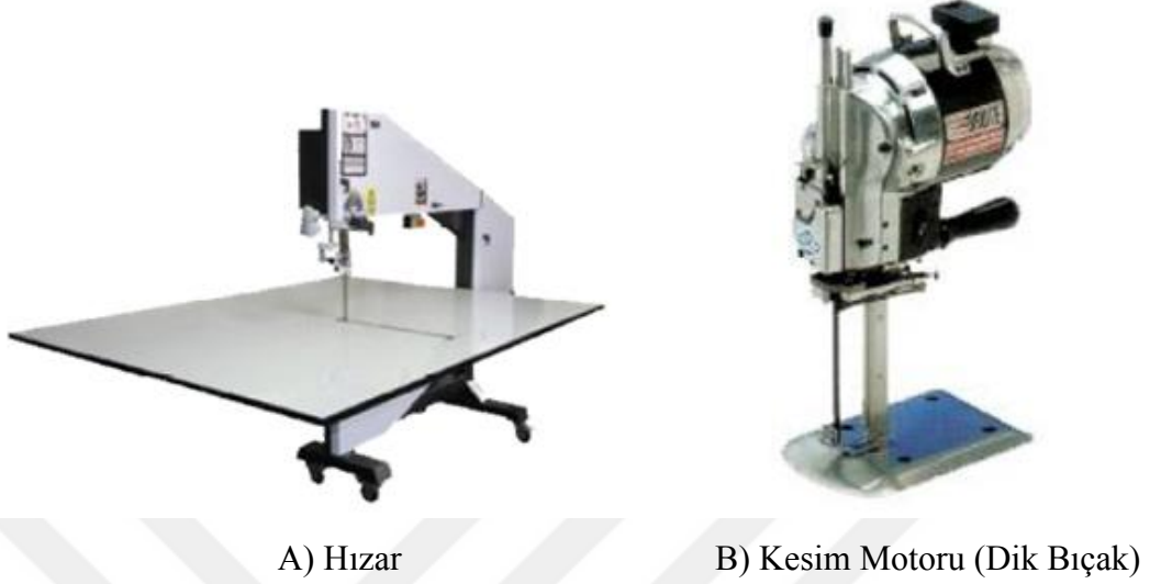
Şekil 2.7. Kesimhanede Kullanılan Makineler ( www.arismakina.com , 2015)
