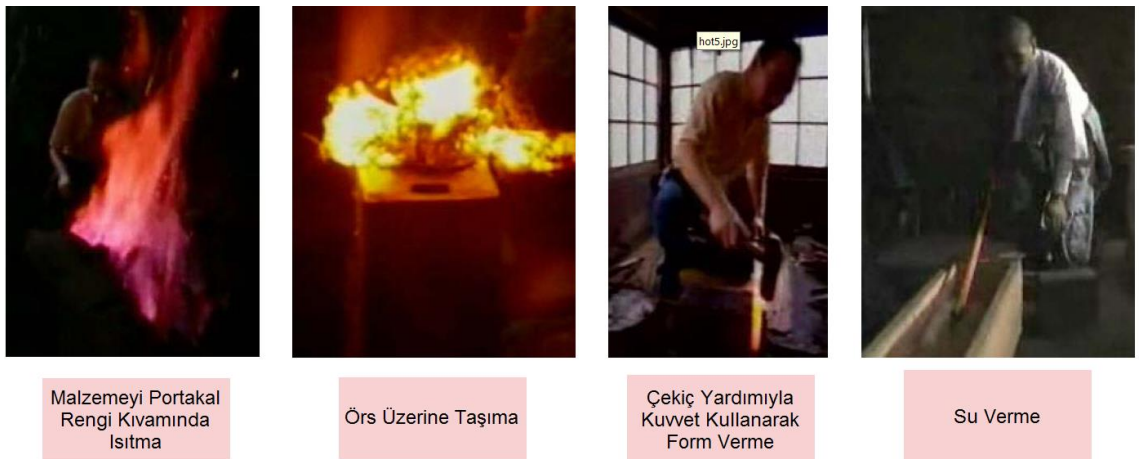
Şekil 2.2.1. Katana imalatı şematik gösterimi (Shapiro 2009)
