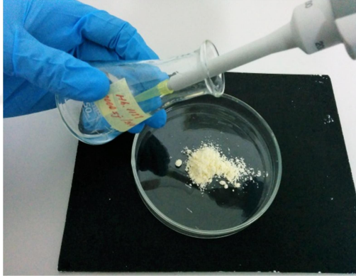
Şekil 3.17. Tartımı yapılan maddelerin içerisine IJ+saf su solüsyonu koyulması
