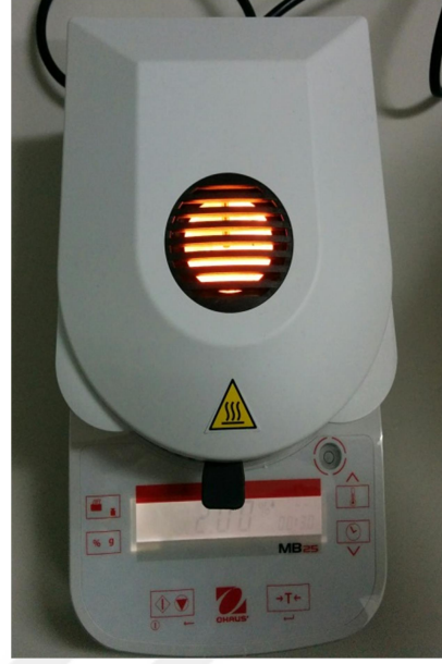
Şekil 3.16. Formülasyon ortamlarındaki nemi belirlemeye yarayan nem tayin cihazı
