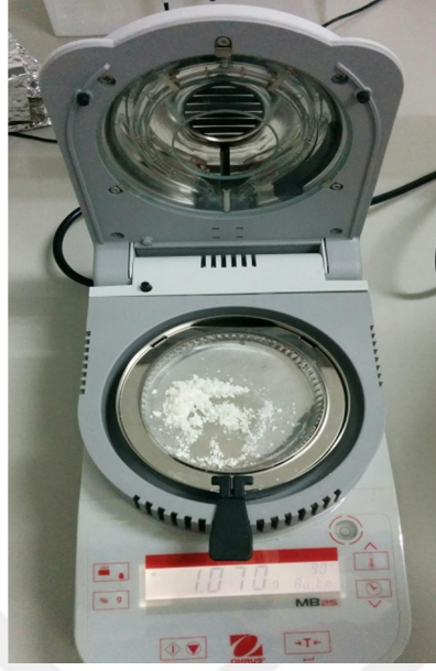
Şekil 3.16. Formülasyon ortamlarındaki nemi belirlemeye yarayan nem tayin cihazı
