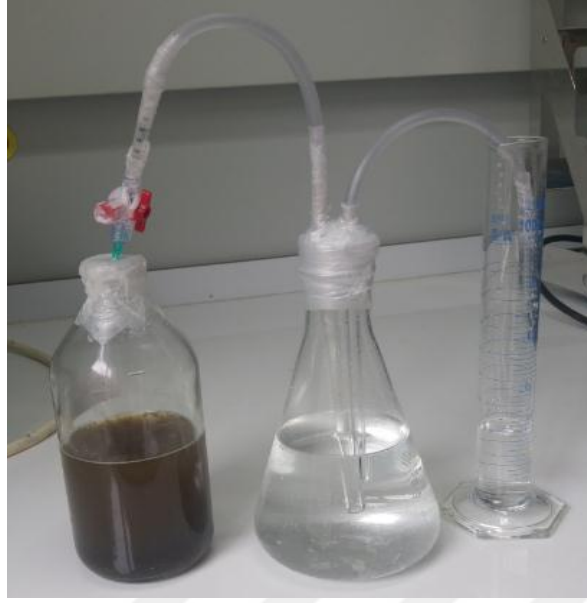
Şekil 3.2. Biyogaz miktarı ölçüm düzeneği
