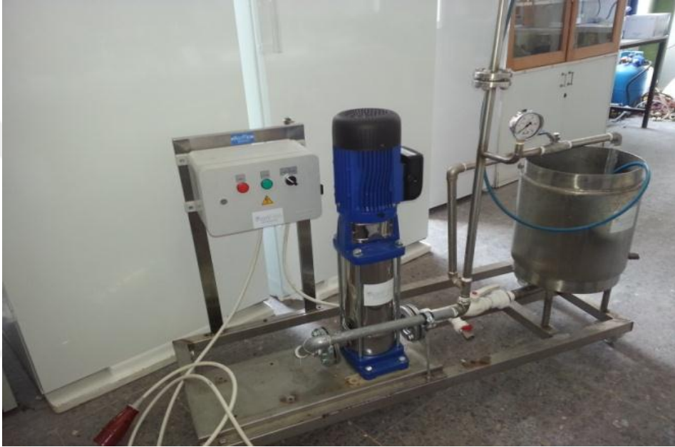
Şekil 3.1. Çalışmada kullanılan hidrodinamik kaviteasyon sistemi
