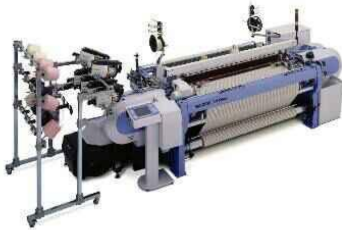
Resim 8.1. Sulzer G6300 esnek kancalı dokuma makinesi
