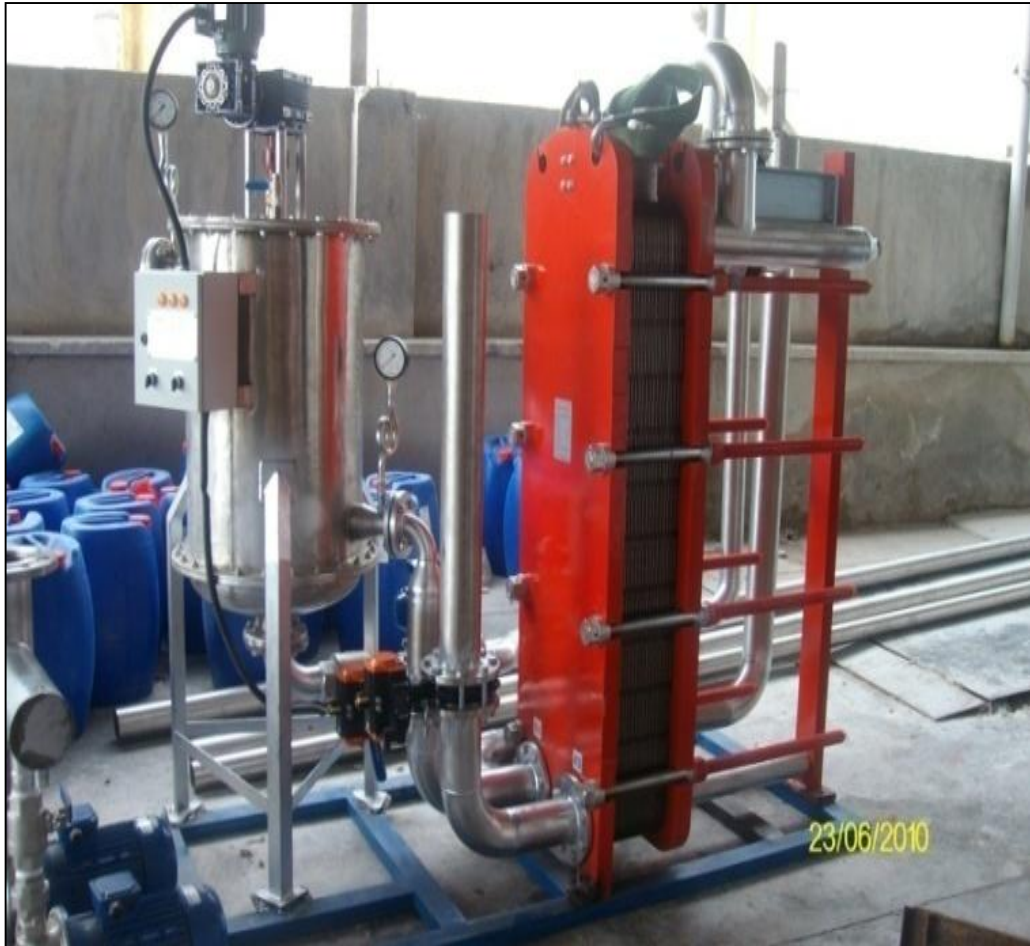
Şekil 9.2 Plakalı ısı deęiřtiricisi ve otomatik yıkamalı filtre
