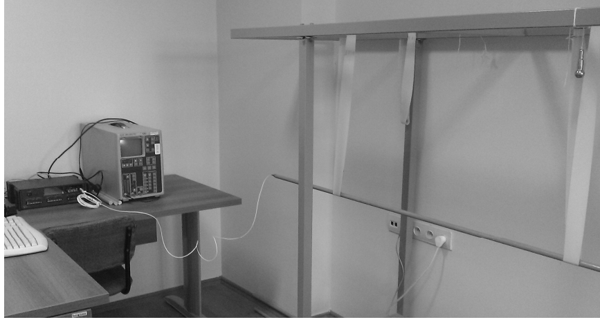
Resim 4.1. Kompozit çubuğun boyuna titreşim analizi için konumlandırılması
