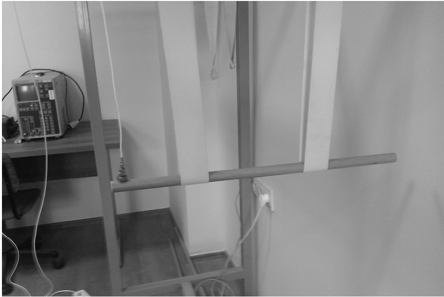
Resim 4.3. Kompozit çubuğun eğilme titreşim analizi için konumlandırılması
