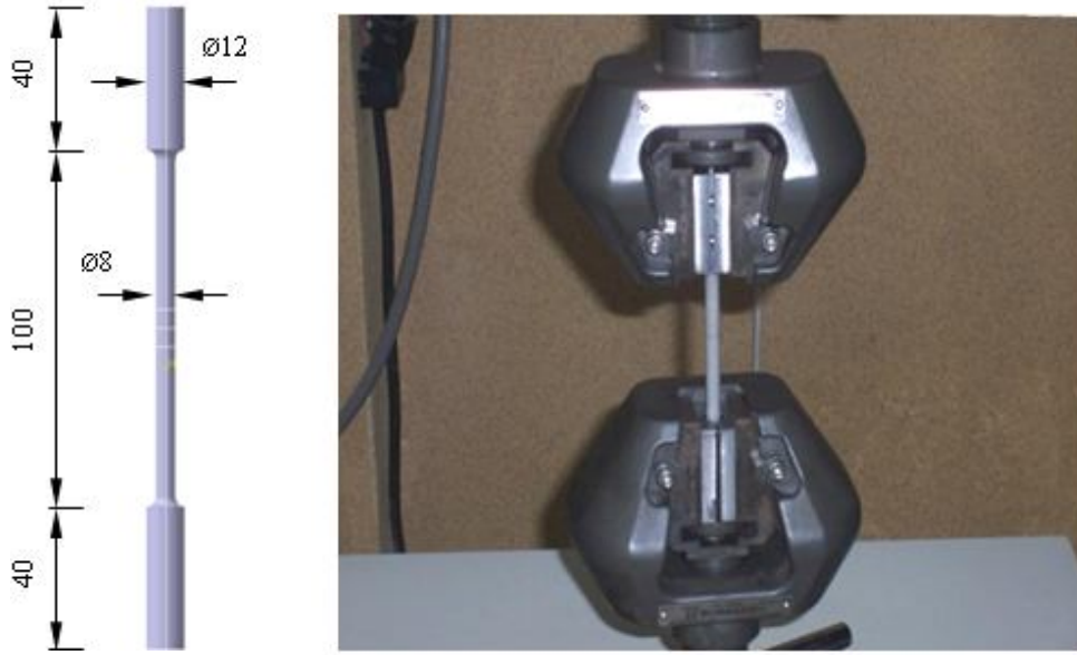
Resim 4.2. Kompozit çubuk çekme numunesi ve çekme testi
