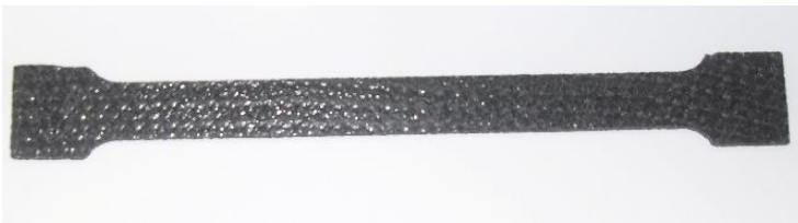
Resim 5.7. Kompozit plakaların çekme testi için belirlenen boyutlarda kesilmiş hali
