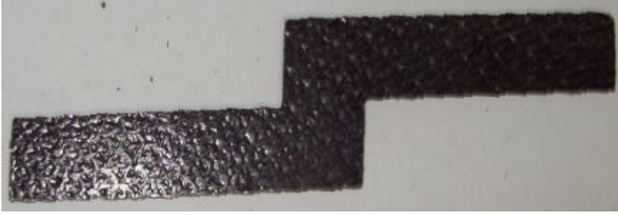
Resim 5.11. Kompozit plakaların kayma testi için belirlenen boyutlarda kesilmiş hali
