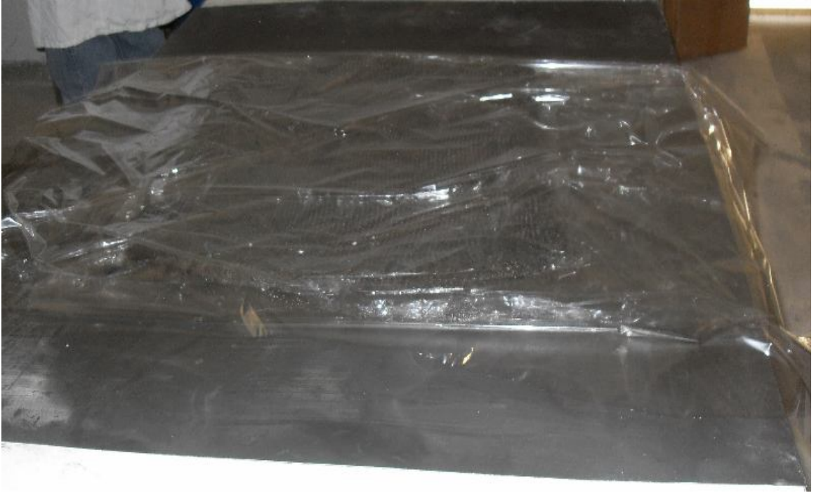
Resim 5.5. Kompozit malzemenin prese konulmadan önceki hali
