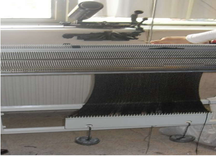
Resim 5.1. Karbon kumaşların örülerek elde edilmesi
