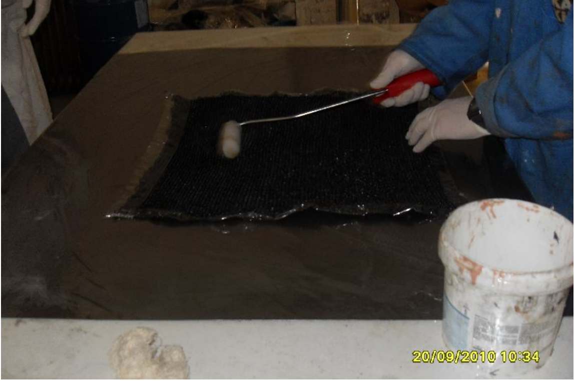
Resim 5.4. Kompozit malzeme üretimi (Reçinenin sürülmesi)
