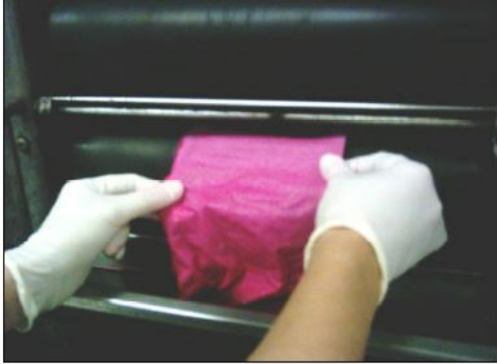
Resim 2.4 Kumaşın silindirler arasından geçişi [51]
