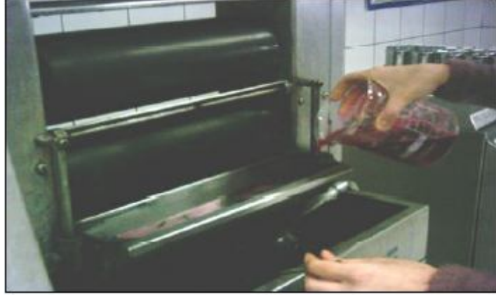
Resim 2.1 Fulard makinesinin teknesi [51]
