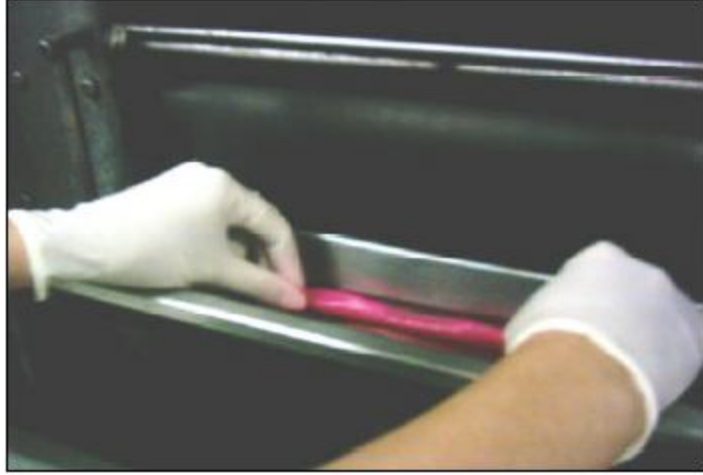
Resim 2.3 Kumaşın tekneye daldırılması [51]
