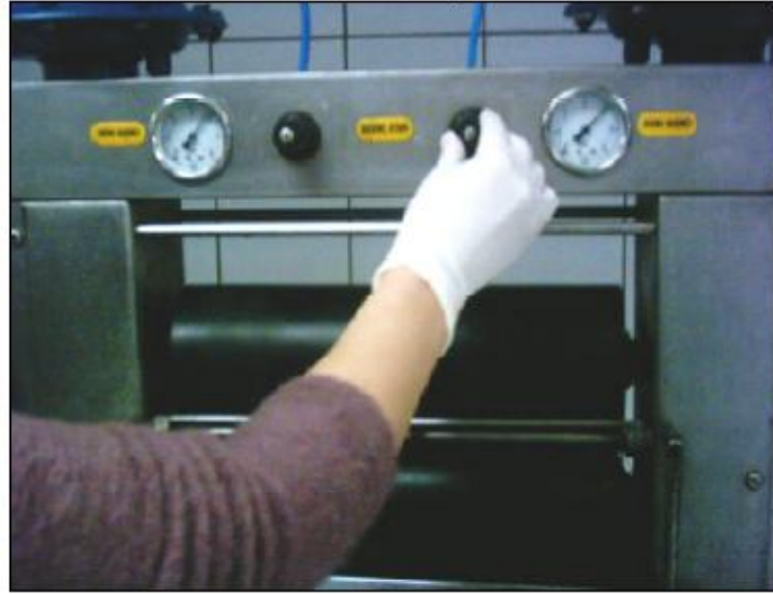
Resim 2.2 Sıkma silindirlerinin basıncı ve kumaş geçiş hızı ayarı [51]
