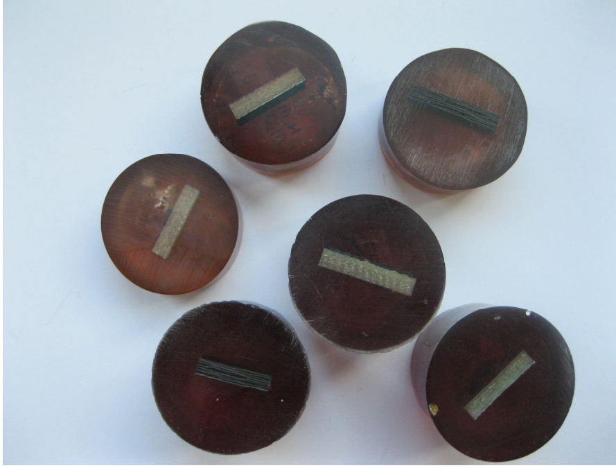
Resim 5.24. İnceleme için bakalite alınmış numuneler
