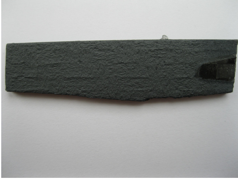
Resim 5.6. Karbon elyaf takviyeli kompozit malzeme üzerine Al_2O_3+TiO_2 kaplanmış numune
