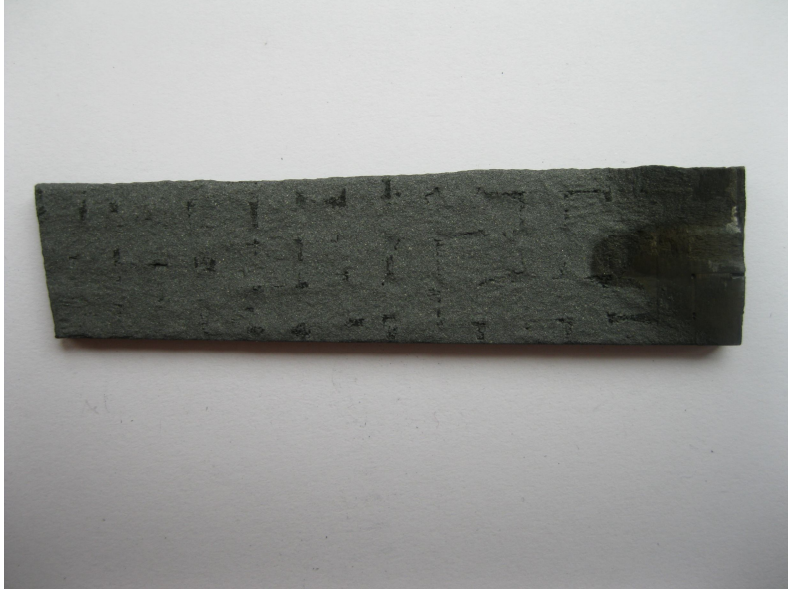
Resim 5.9. Karbon elyaf takviyeli kompozit malzeme üzerine CrO 3 kaplanmış numune
