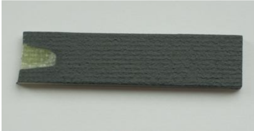
Resim 5.5.Cam elyaf takviyeli kompozit malzeme üzerine Al_2O_3+TiO_2 kaplanmış numune
