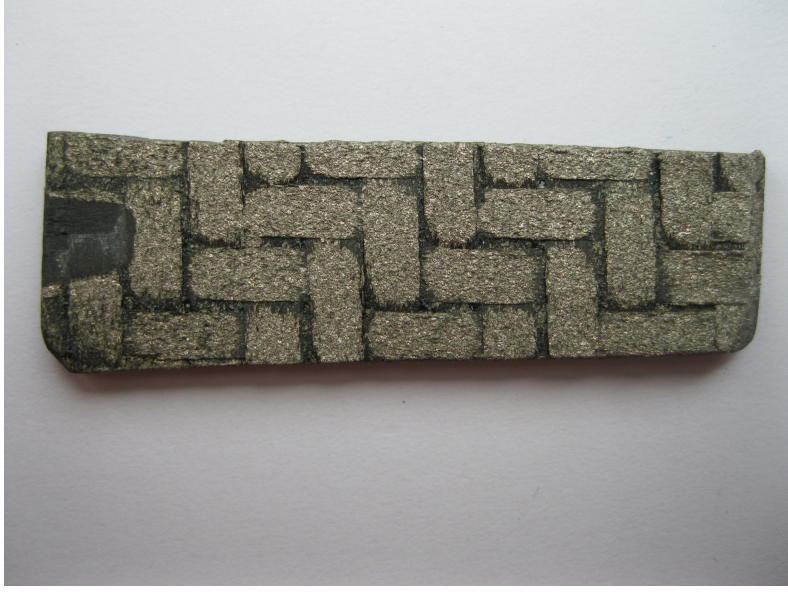
Resim 5.8. Cam elyaf takviyeli kompozit malzeme üzerine NiAl Astar kaplanmış numune
