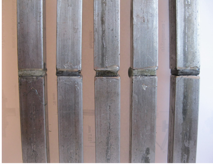
Resim 4.7. Çekme deneyi için hazırlanmış test kuponları
