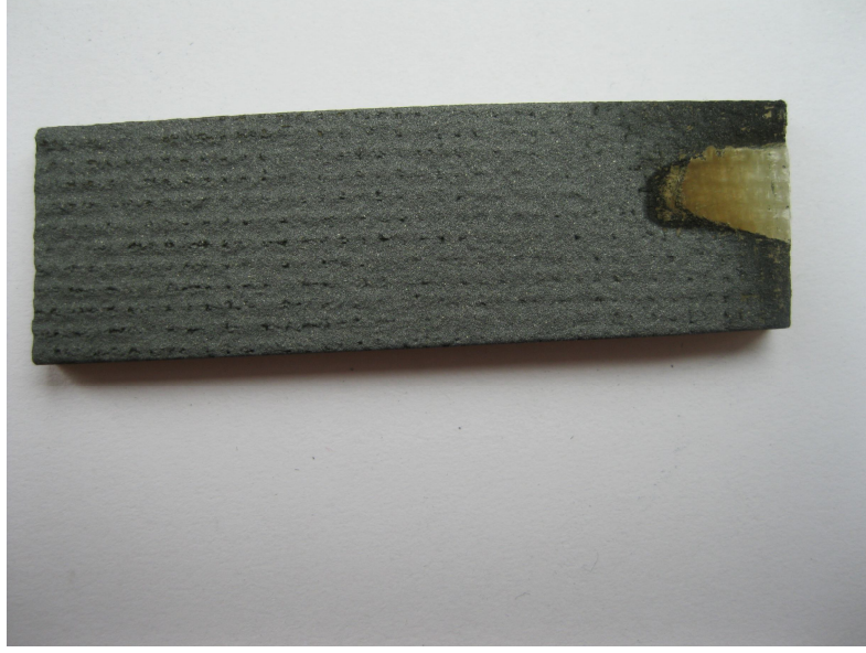
Resim 5.10. Cam elyaf takviyeli kompozit malzeme üzerine \text{CrO}_3 kaplanmış numune
