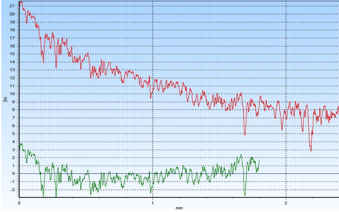
Şekil 7.21 1 mm NiAl+Al 2 O 3 +TiO 2 (%97/3) numuneleri yüzey pürüzlülüğü ölçüm değerleri
