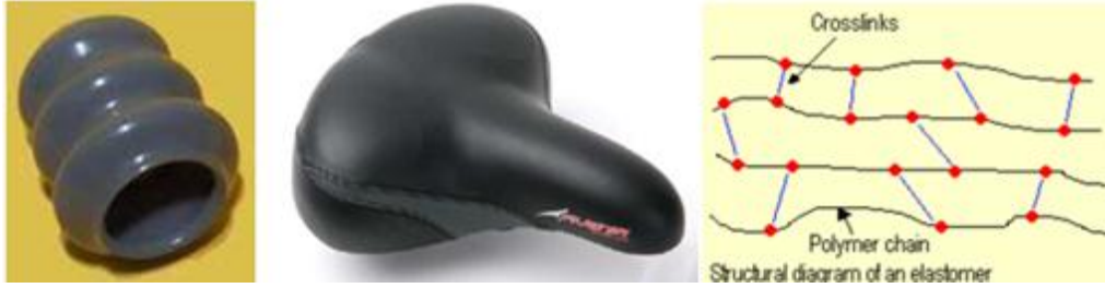
Resim 2.6 Elastomerlerin bağ yapısı ve kullanım alanlarına örnek [6]
