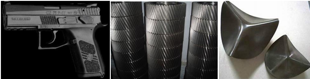
Resim 5.2 Difüzyon İşlemleri uygulanmış ürünler a) Nitrürasyon işlemine tabi tutulmuş tabanca kabzası, b) Sementasyon yapılmış dişli çarklar c) Borlama işlemi yapılmış muldefon [4]
