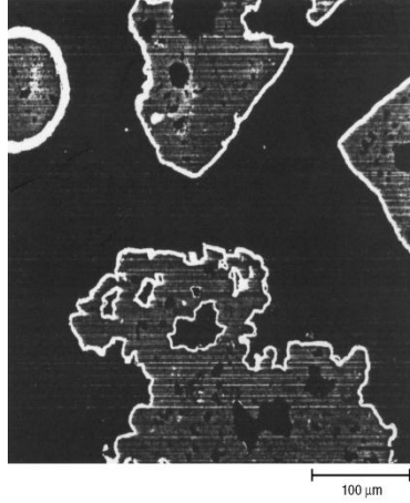
Resim 5.3 Gözenekli yüzey üzerine yapılmış CVD işlemi [23]
