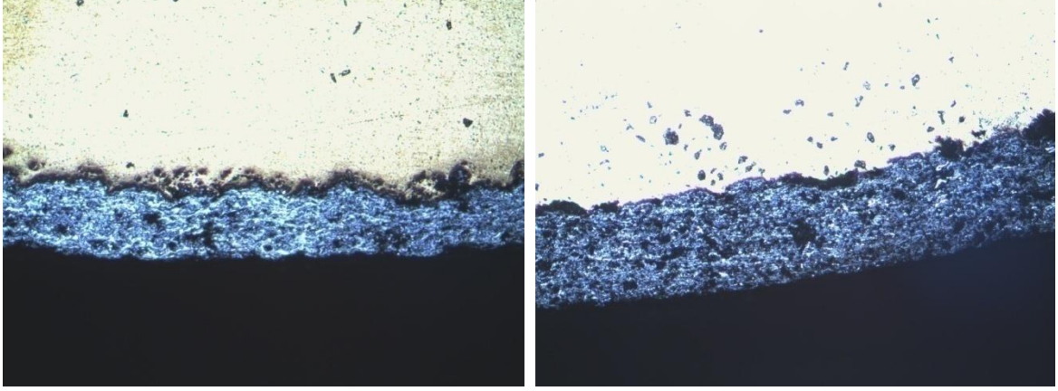
(a) (b) Resim 7.13 a) 0,3mm Cr 2 O 3 numunesinin mikroyapısı (x50), b) 0,5mm Cr 2 O 3 numunesinin mikroyapısı (x50)
