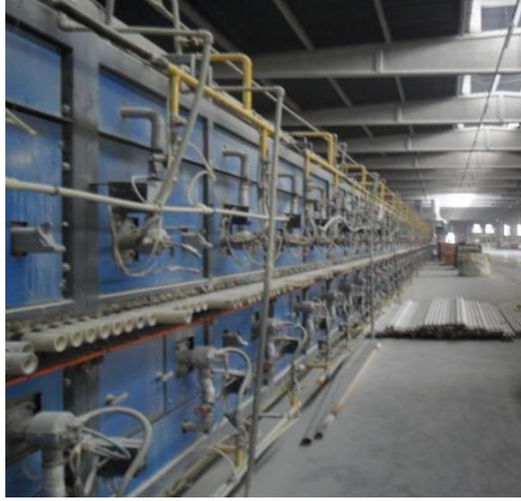
Şekil 2.11 Hidrojen zenginleştirme prosesi entegre edilmiş tek katlı seramik fırını
