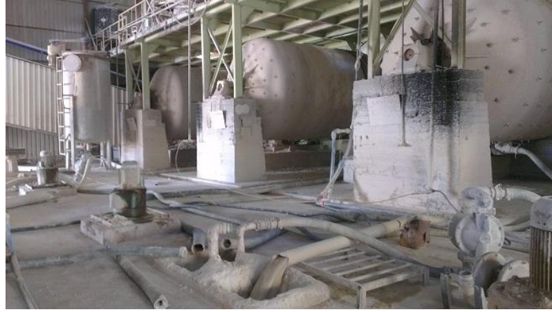
Şekil 2.3 Öğütücü bilyeli sulu değirmenler ve karıştırıcı havuzları
