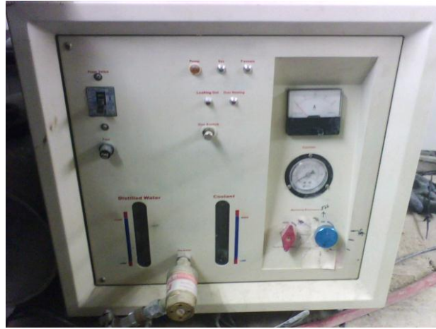
Şekil 8.1 Hidrojen üretim ünitesi "Hydrobor"
