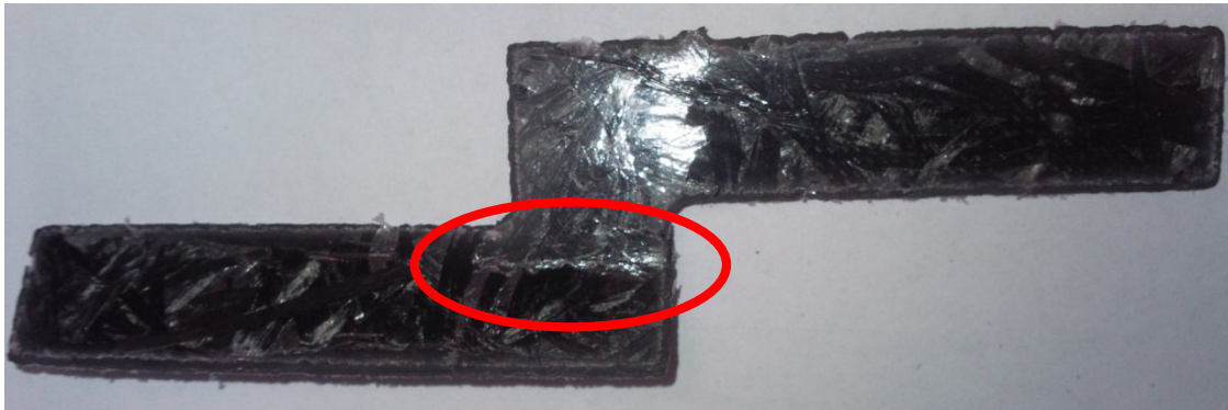
Resim 5.12. Kayma testi sonrası malzemedeki hasarlar
