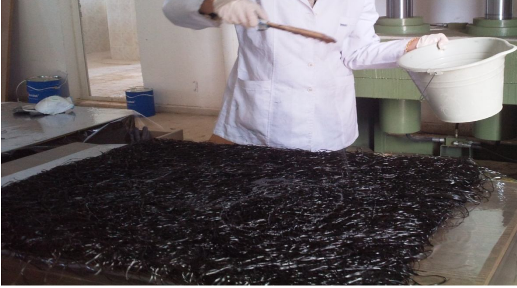
Resim 5.4. Kompozit malzeme üretimi (Reçinenin sürülmesi)
