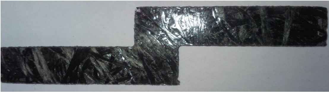
Resim 5.10. Kompozit plakaların kayma testi için belirlenen boyutlarda kesilmiş hali
