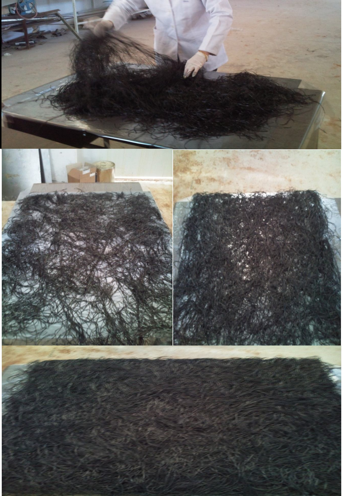
Resim 5.3. Kompozit malzeme üretimi (Liflerin serilmesi)
