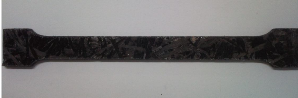
Resim 5.6. Kompozit plakaların çekme testi için belirlenen boyutlarda kesilmiş hali
