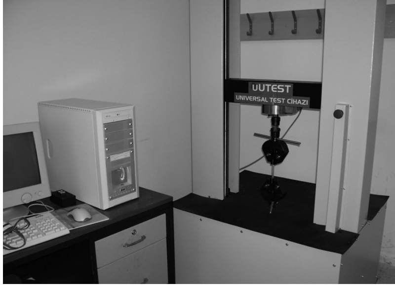
Resim 5.5. Üniversal test cihazı
