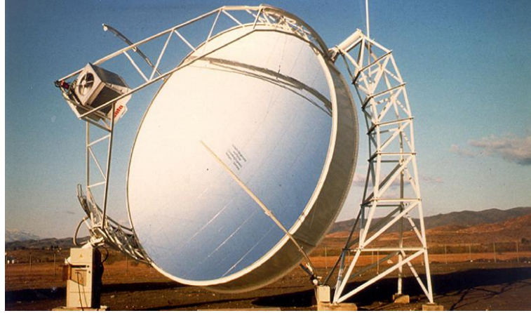
Şekil 3.5.2 Schlaich Bergermann şirketine ait olan Stirling motor [18]
