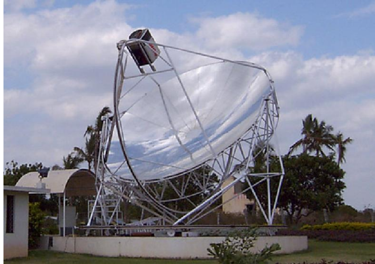
Şekil 3.5.5 KEMS şirketine ait olan Stirling motor [18]
