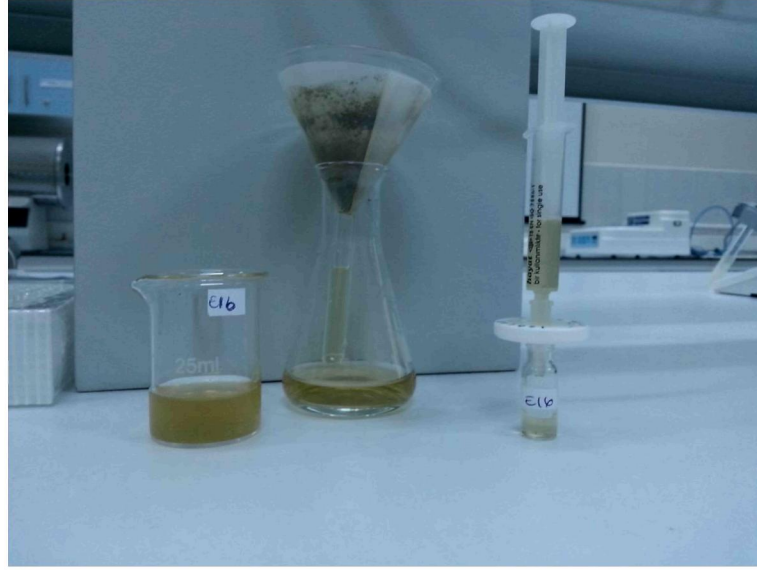
Resim 2.3. 0,45 mikronluk membran ile vial filtrasyon işlemi (sağda)
