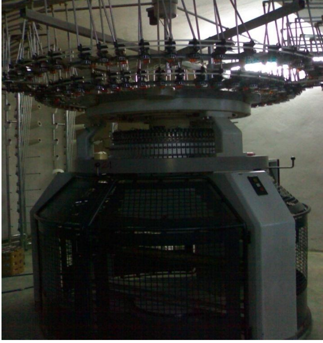
Resim 2.1. Mayer & Cie firmasına ait yuvarlak örme makinesi
