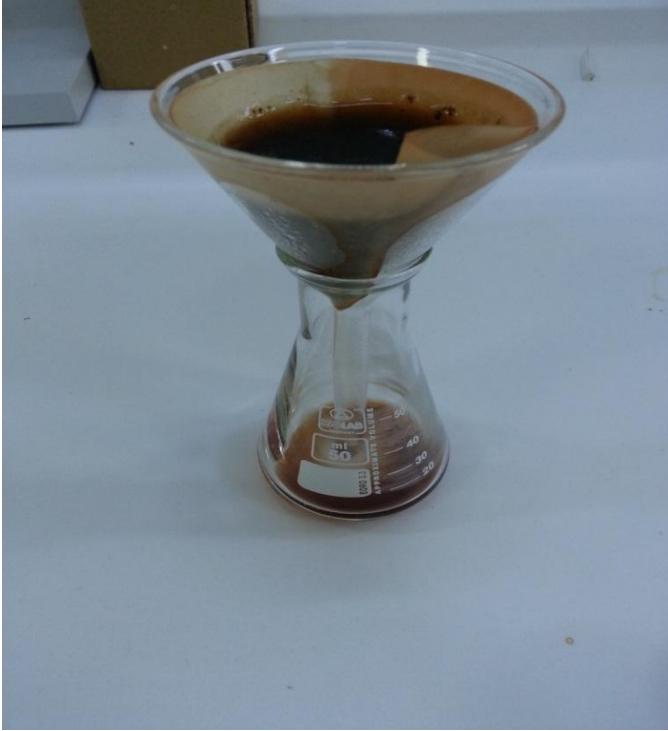
Resim 6. Ultrasonik banyo sonrası ilk filtrasyon işlemi
