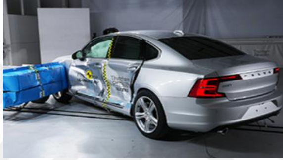
Şekil 3.4. Yan darbe testi uygulanmış bir otomobil ( http://www.euroncap.com/en/results/volvo/s90/26099 , 2017)
