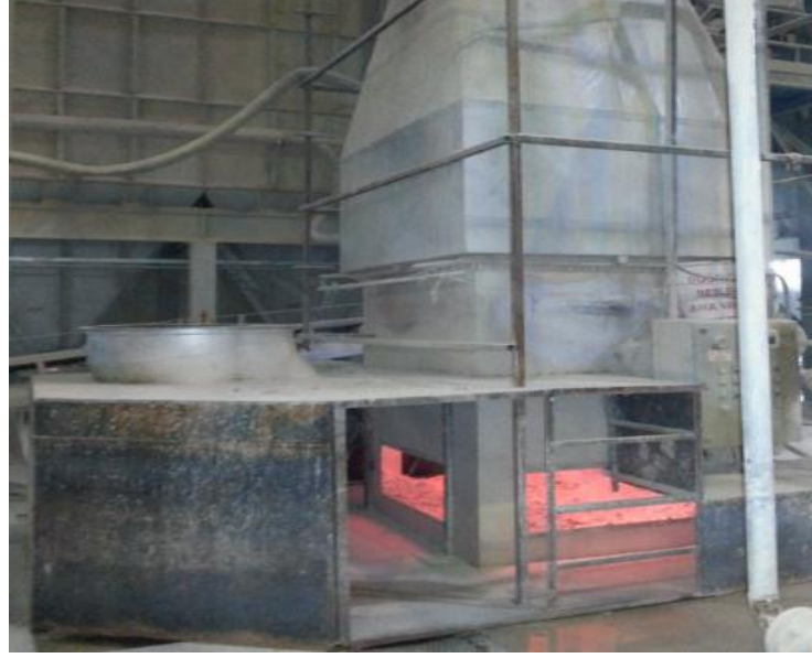
Resim 6.12. Püskürtmeli kurutucu atık ısı giriş bölümü
