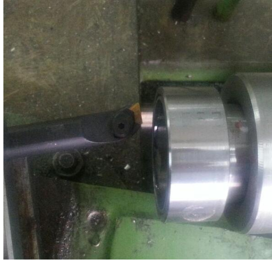
Şekil 4.4. Silindirik masuralı rulmanın dış bileziğinin yuvarlanma yolu üzerine yapay hatanın oluşturulması
