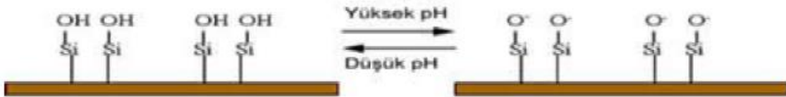
Şekil 2.6. Kapiler iç yüzeyinde silanol gruplarının iyonlaşmasının pH ile değişimi
