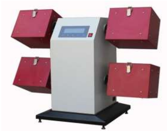
Şekil 8 : ICI Boncuklaşma Kutu Test Cihazı
