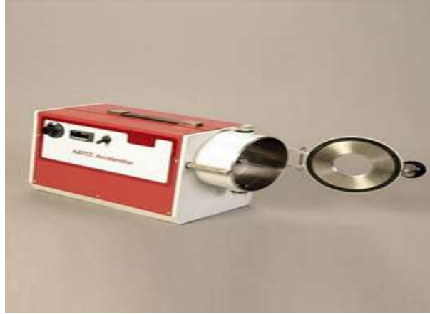
Şekil 5 : AATCC Aşındırma Test Cihazı (Akseleratör)
