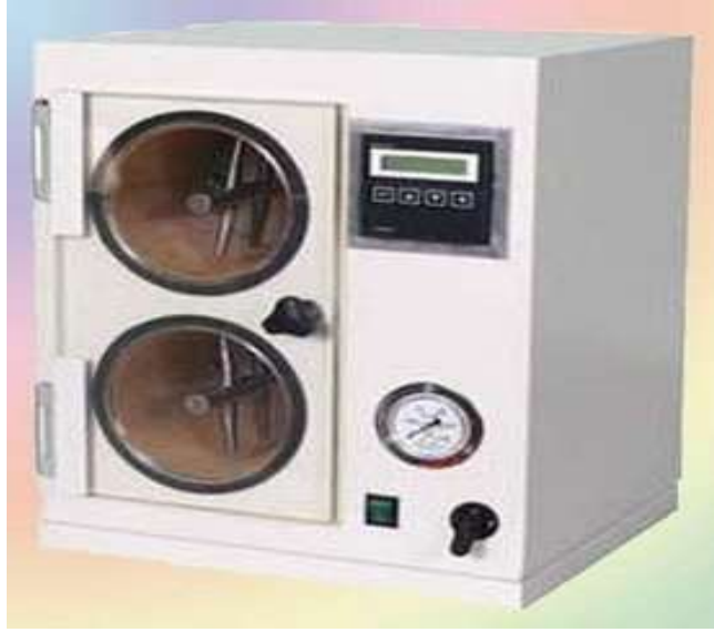
Şekil 4 : Random Tumble Boncuklaşma Test Cihazı
