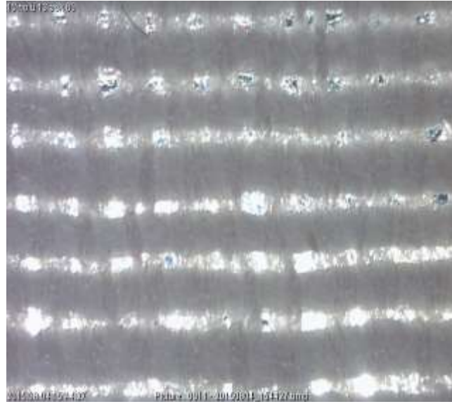
Şekil 134 : 10 Nolu numunenin 60 büyütme ile kumaş görüntüsü (atkı sıklığı 13 atkı/cm- atkı no : 6 Ne)
