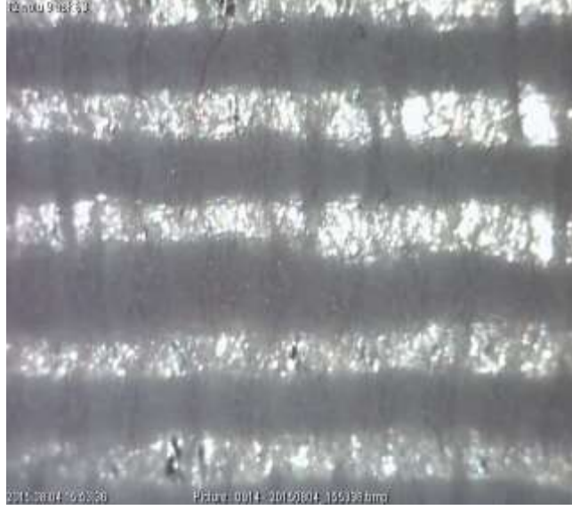
Şekil 159 : 12 Nolu numunenin 63 büyütme ile kumaş görüntüsü (atki sıklığı 9 atki/cm- atki no : 6 Ne)
