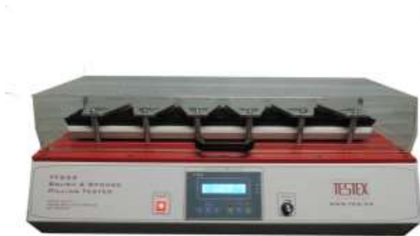
Şekil 6 : Fırça ve Sünger Boncuklaşma Testi
