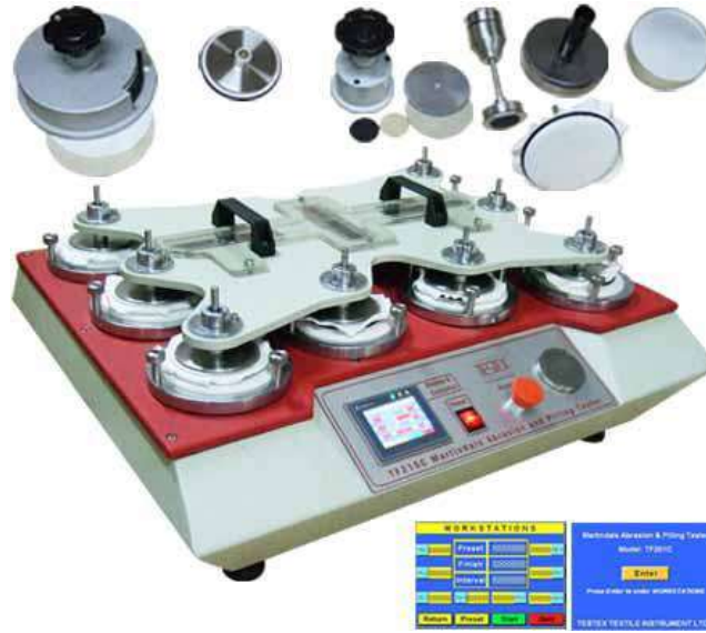
Şekil 9 : Martindale Aşındırma Test Cihazı
