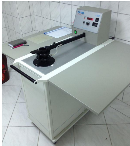
Resim 5.10. Textest FX 3300 hava geçirgenlik cihazı
