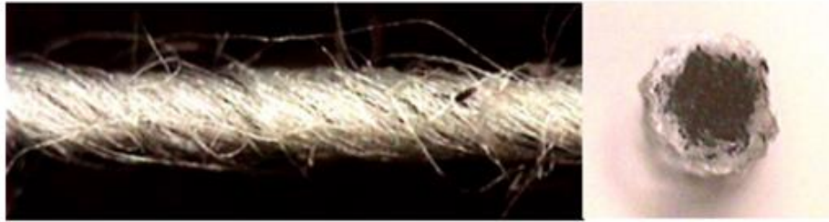
Resim 3.5. Özlü friksiyon iplik yapısı; (a) İplik yüzey görüntüsü, (b) İplik enine kesit görüntüsü [71]
