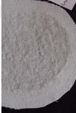
Şekil 4.4. 16, 17, 18, 37, 38, 39 numaralı test numunelerinin aşınma sonrası yüzey görüntüsü
