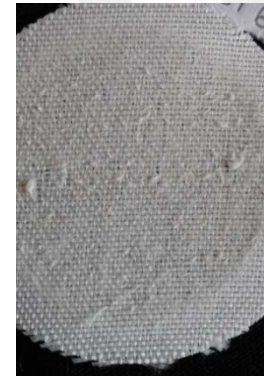
Şekil 4.8. 22, 23, 24, 49, 50, 51 numaralı test numunelerinin aşınma sonrası yüzey görüntüsü
