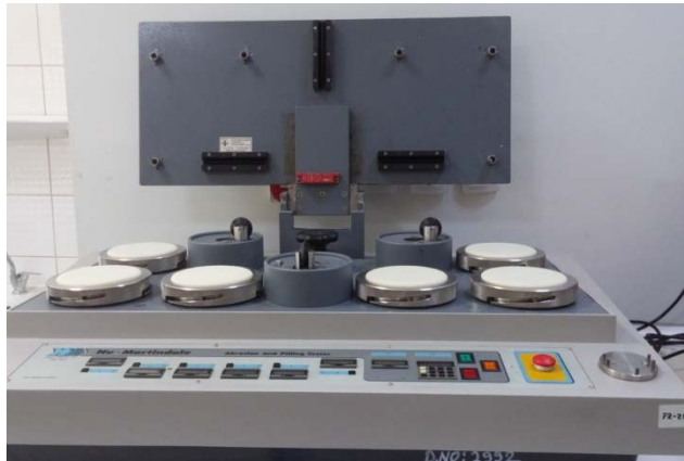
Şekil 3.1. Martindale aşındırma test cihazı (Nu-Martindale Abrasion and Pilling Tester)
