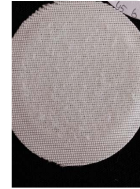
Şekil 4.6. 10, 11, 12, 43, 44, 45 numaralı test numunelerinin aşınma sonrası yüzey görüntüsü
