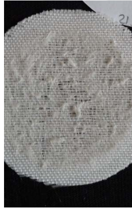
Şekil 4.9. 19, 20, 21, 52, 53, 54 numaralı test numunelerinin aşınma sonrası yüzey görüntüsü
