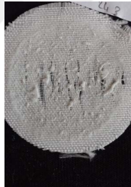
Şekil 4.8. 22, 23, 24, 49, 50, 51 numaralı test numunelerinin aşınma sonrası yüzey görüntüsü
