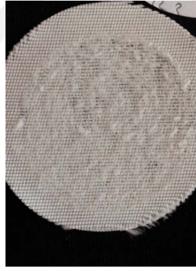
Şekil 4.6. 10, 11, 12, 43, 44, 45 numaralı test numunelerinin aşınma sonrası yüzey görüntüsü
