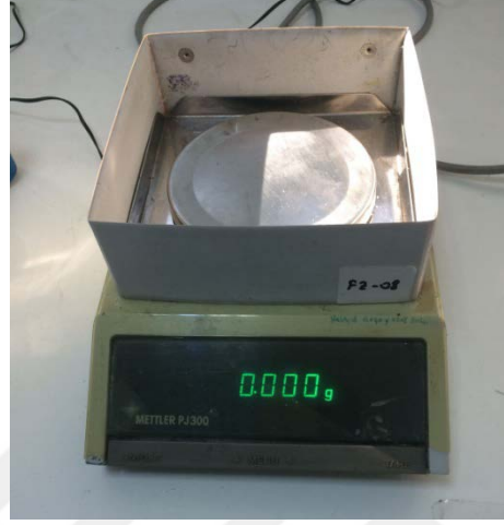
Şekil 3.2. Hassas terazi ( Mettler PJ300)
