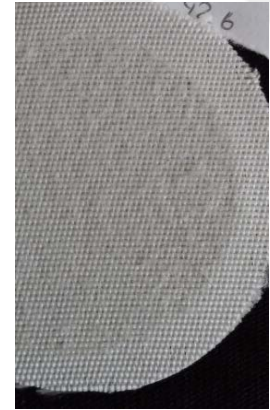
Şekil 4.5. 13, 14, 15, 40, 41, 42 numaralı test numunelerinin aşınma sonrası yüzey görüntüsü
