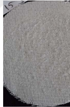
Şekil 4.5. 13, 14, 15, 40, 41, 42 numaralı test numunelerinin aşınma sonrası yüzey görüntüsü
