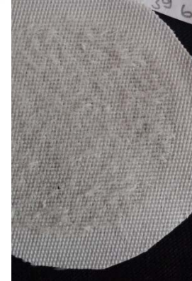
Şekil 4.4. 16, 17, 18, 37, 38, 39 numaralı test numunelerinin aşınma sonrası yüzey görüntüsü
