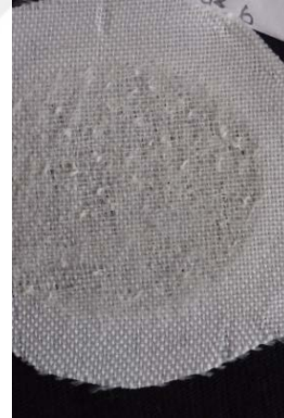
Şekil 4.7. 25, 26, 27, 46, 47, 48 numaralı test numunelerinin aşınma sonrası yüzey görüntüsü
