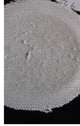
Şekil 4.9. 19, 20, 21, 52, 53, 54 numaralı test numunelerinin aşınma sonrası yüzey görüntüsü
