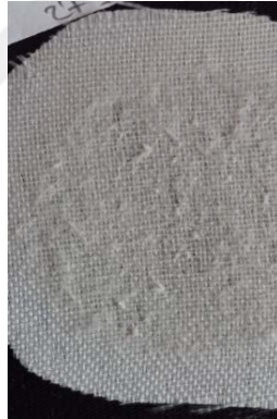
Şekil 4.7. 25, 26, 27, 46, 47, 48 numaralı test numunelerinin aşınma sonrası yüzey görüntüsü
