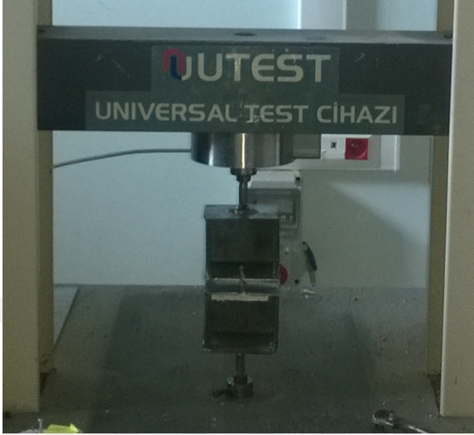
Resim 3.12. Universal test cihazında vida tutma mukavemeti deneyi
