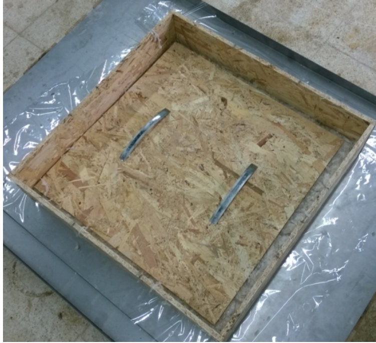
Resim 3.5. Kalıp içerisinde ön presleme işlemi
