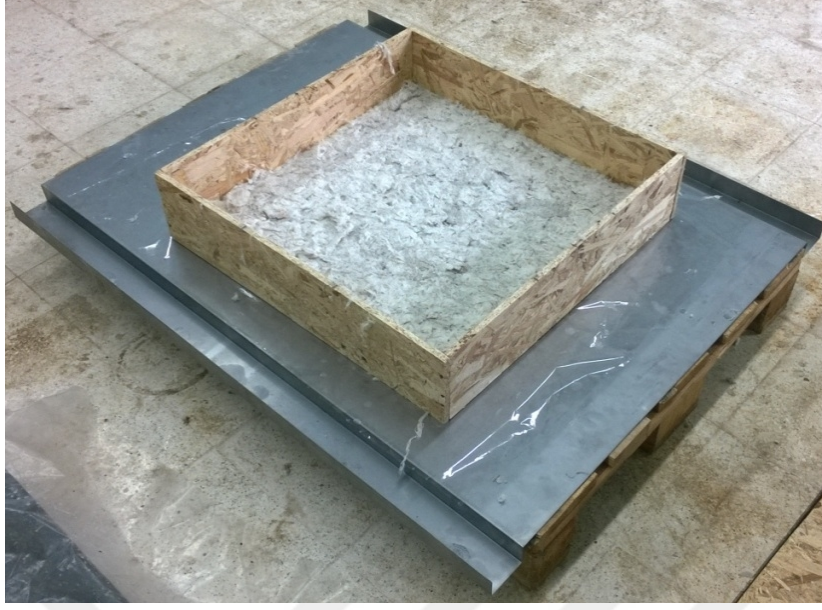
Resim 3.4. Tutkallanmış elyafın kalıp içerisine tiftiklenerek doldurulduktan sonraki hali
