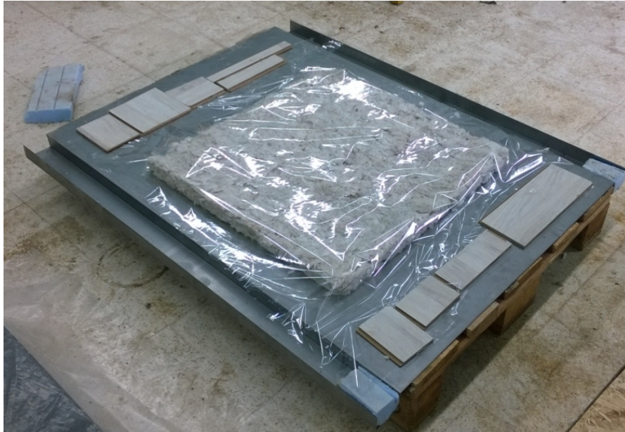
Resim 3.7. Üst polyester film ve takozların konulması
