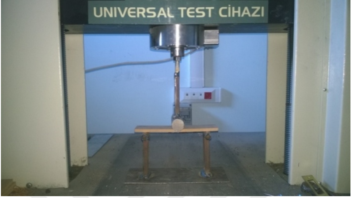
Resim 3.9. Universal test cihazında eğilme direnci deneyi
