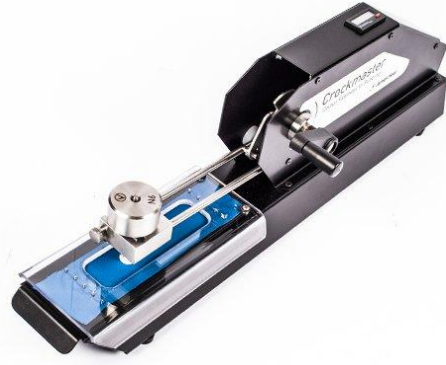
Şekil 2.10. Kuru ve yaş sürtme haslığında kullanılan crockmeter test cihazı ( www.james-heal.co.uk , 2016)
