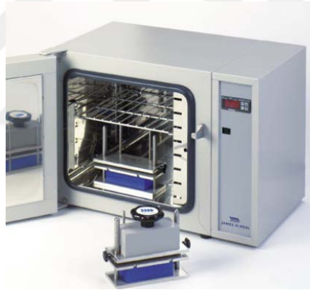
Şekil 2.9. Su haslığında kullanılan perspirometre cihazı ve etüv ( www.james-heal.co.uk , 2016)
