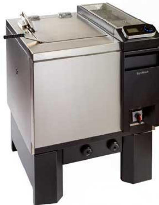
Şekil 2.8. Yıkama haslığında kullanılan Gyrowash makinesi ( www.james-heal.co.uk , 2016)
