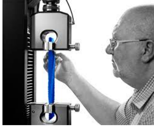
Şekil 2.11. Kumaş kopma mukavemeti testleri için kullanılan cihaz ( www.james-heal.co.uk , 2016)
