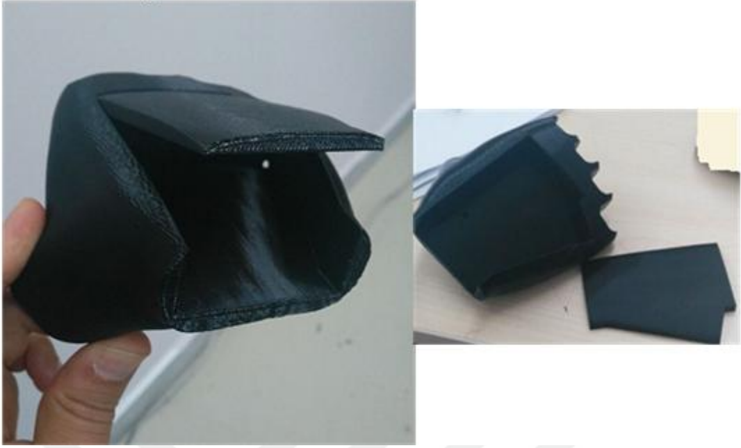
Resim 6.30. Elastik bağlantıları olan elin avuç içi mekanizması
