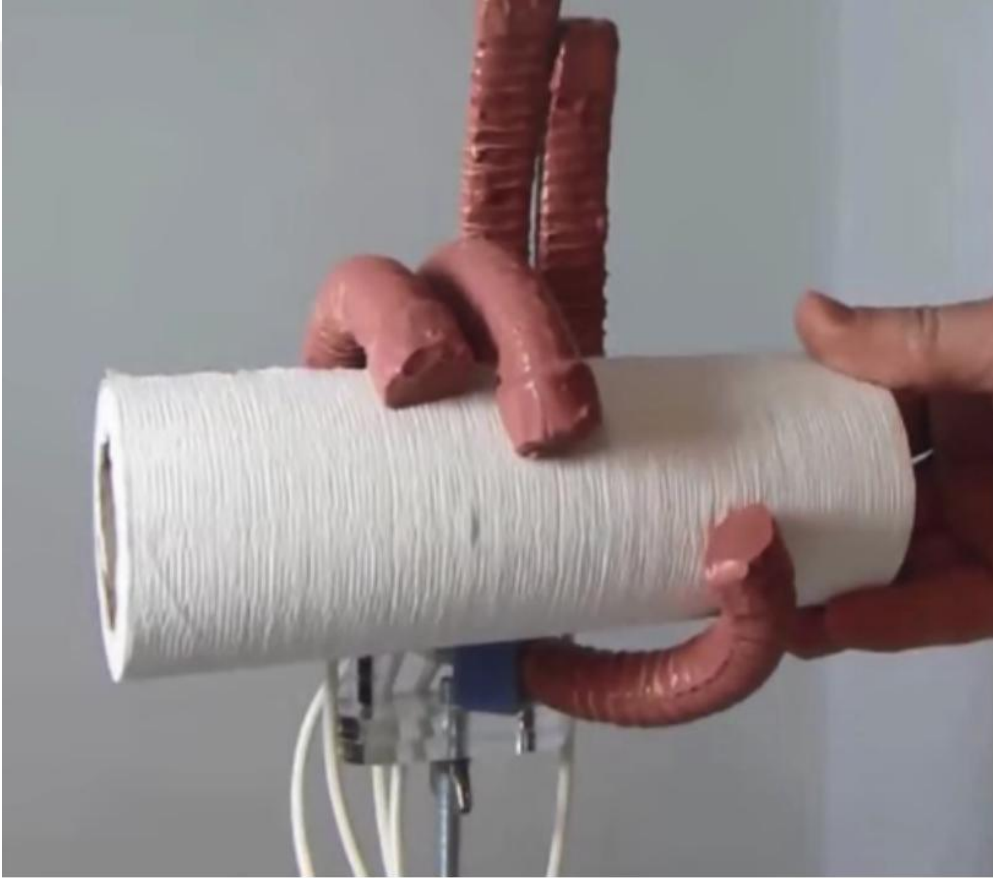
Resim 4.6. Tekstil katkılı aktüatörden protez el [75]
