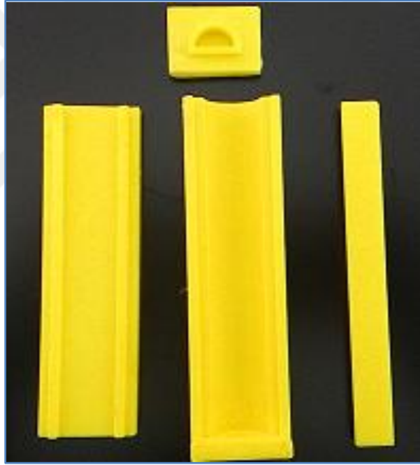
Resim 6.1. Pnömatik silikon parmak kalıbı
