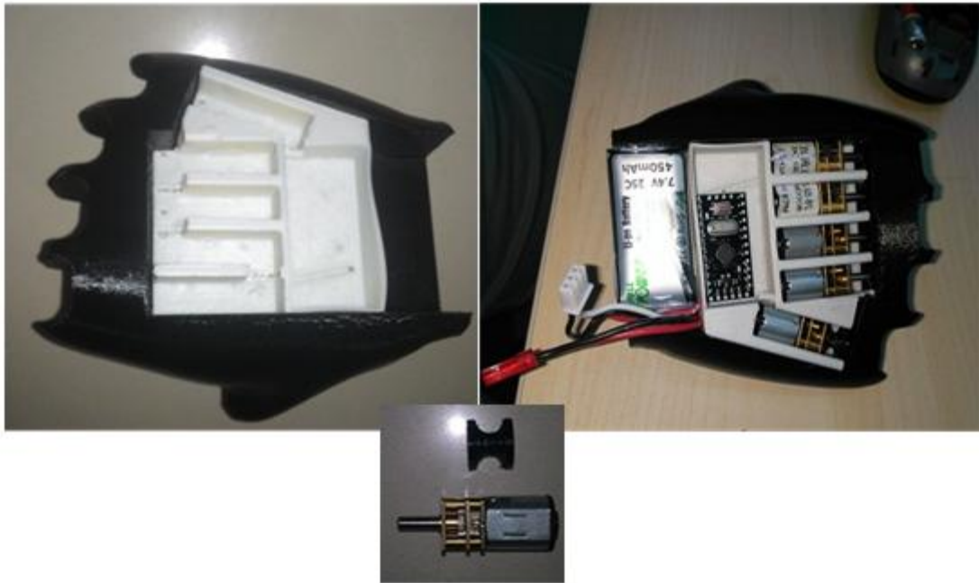
Resim 6.31. Elastik bağlantıları olan protez elin avuç içi mekanizması
