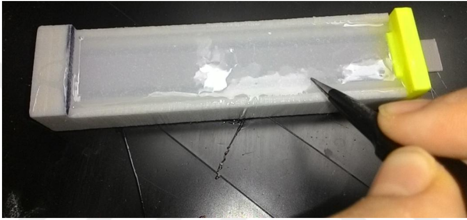
Resim 6.5. Kalıba dökülen silikondaki baloncukların patlatılması
