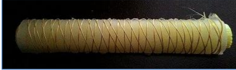
Resim 6.8. Kevlar ile sarılması
