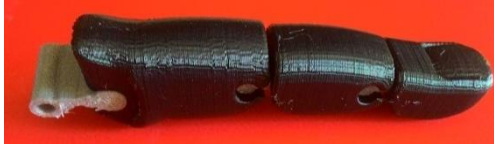
Resim 6.29. Elastik bağlantısı ile protez parmak
