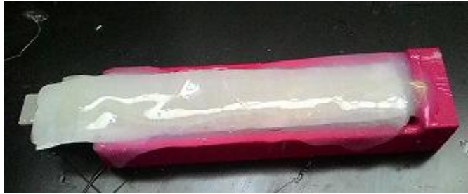
Resim 6.9. Kevlar ile kaplama sonrası tekrar silikon kaplama işlemi
