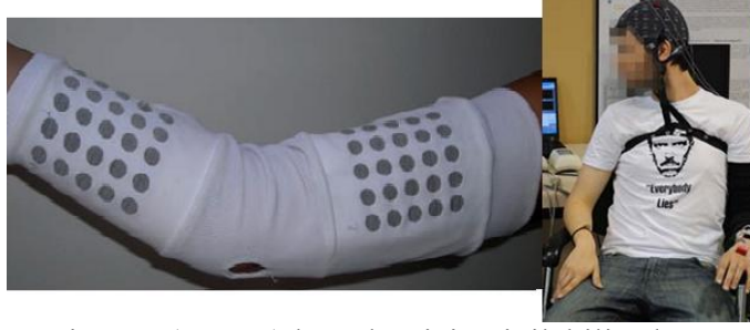
Resim 2.1 Titreme (tremor) hastalığı için giyilebilir ölçüm ve değerlendirme robotu (Tremor neurorobot)
