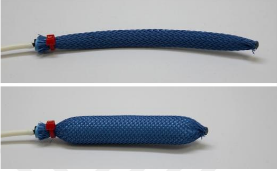
Resim 4.9. McKibben yapay kasın hava basıncı öncesi ve sonrası hali
