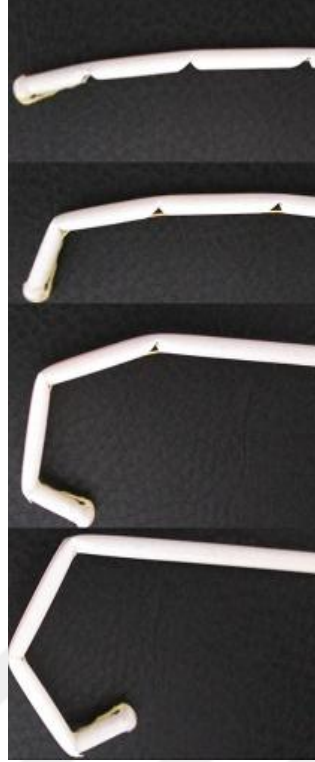
Resim 6.12. Parmak hareketi için kılavuz aktüatör
