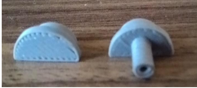
Resim 6.10. Rondela ve hava geçiş kanalı olan tıpa
