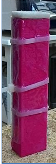
Resim 6.6. Kalıba dökülen silikonun kelepçeler ile kapatılması
