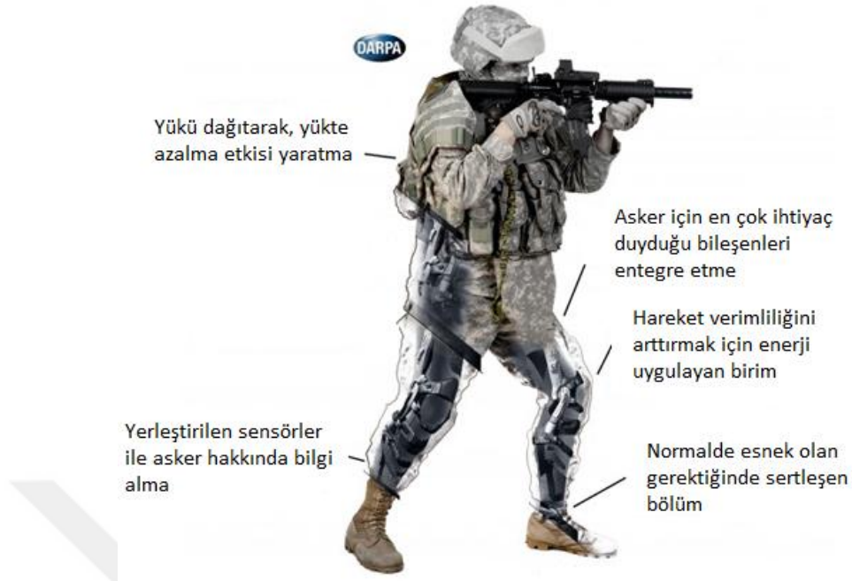
Resim 2.12. Darpa firmasının tasarladığı askerler için giyilebilir dış iskelet
