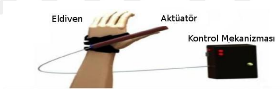
Resim 2.2. Başparmak rehabilitasyonu için aktüatör [5]
