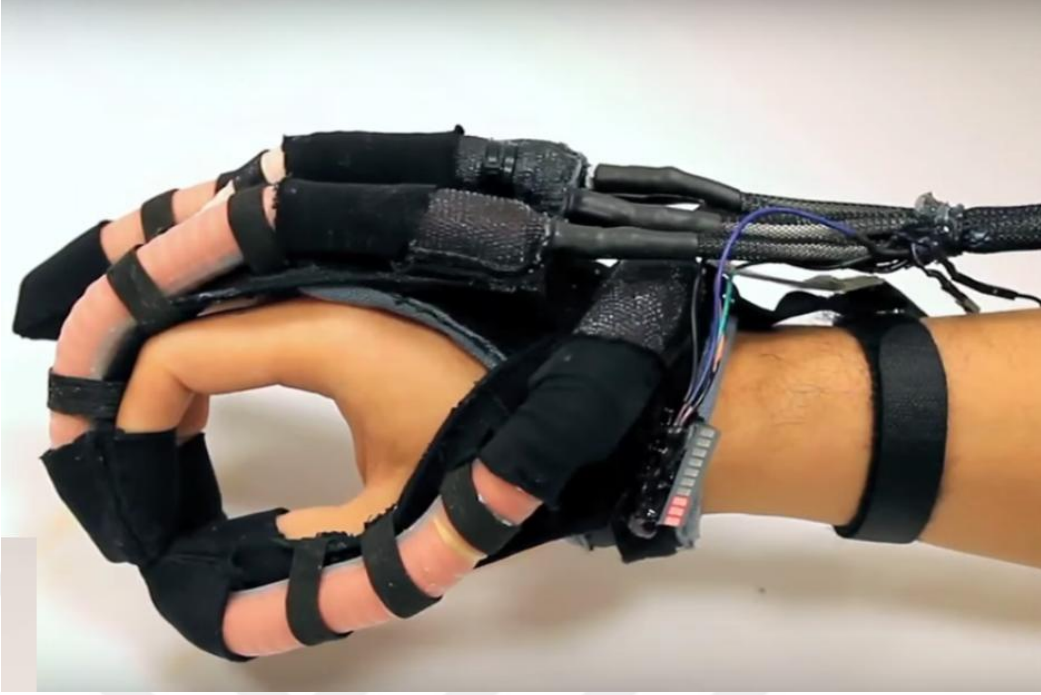
Resim 4.7. Tekstil katkıli aktüatörden giyilebilir rehabilitasyon cihazı
