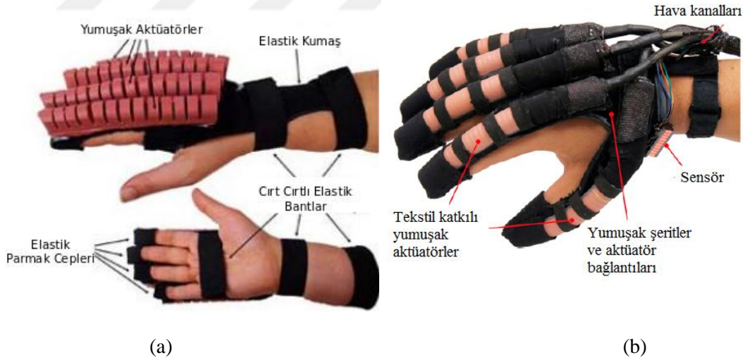
Resim 2.4. (a) Rehabilitasyon eldiveni[7] (b) Tekstil katkıli el rehabilitasyon cihazı [8]
