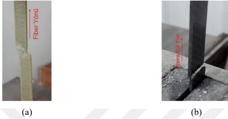
Resim 5.6 Fiber ve fibere dik yöndeki kırılma hasarları
