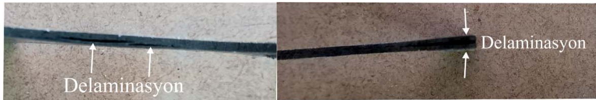
Resim 6.4 Asit ortamının karbon/epoksi kompozitte sebep olduğu hasarlar
