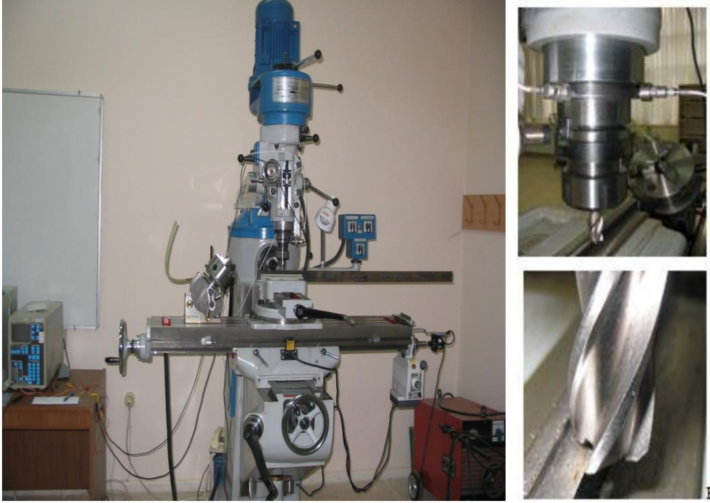
Resim 3.1 Deneyler için kullanılan freze tezgâhı, ivmemetre konumları ve kesme derinlikleri.
