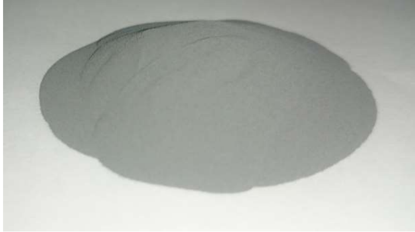
Resim 4.5 NiCr 80/20 bağlayıcı tozun görüntüsü
