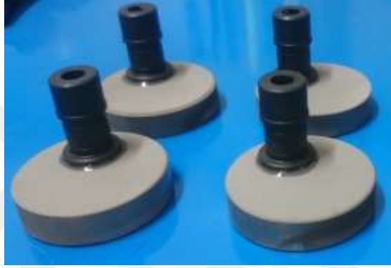
Resim 5.11 Deney aparatlarının numunelere yapıştırılmış hali
