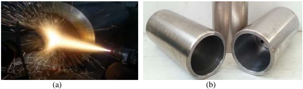
Resim 3.1 a) Tel Alev Sprej Uygulaması [36] b) Toz Alev Sprej Uygulaması [36]
