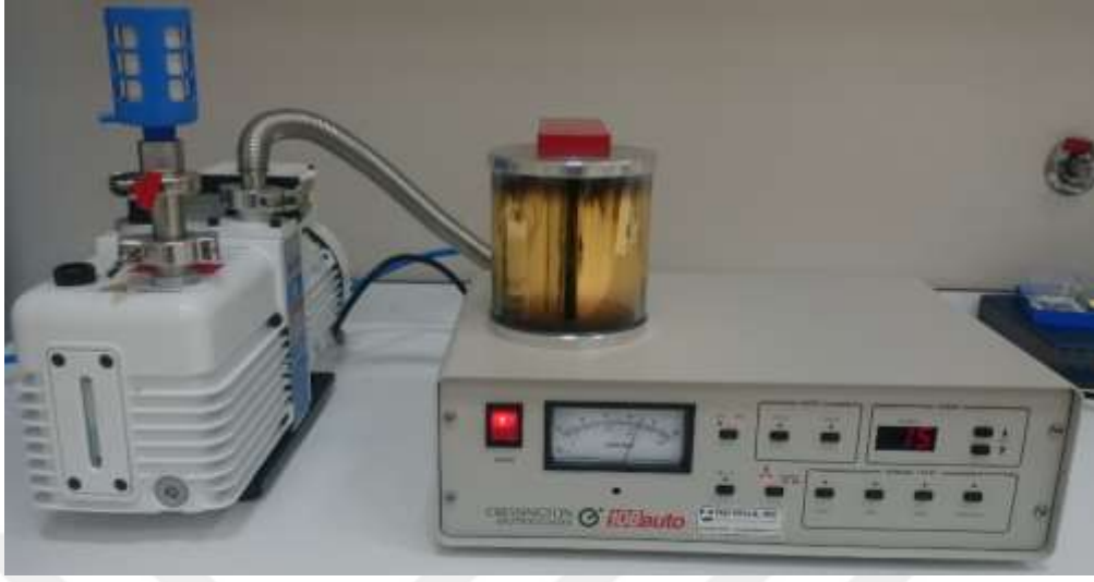
Resim 5.8 CRESSINGTON Altın kaplama cihaz görüntüsü
