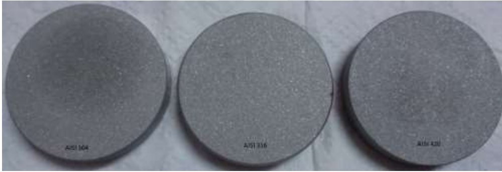
Resim 4.10 Altlık malzemelerinin kumlama işlemi sonrası görüntüsü
