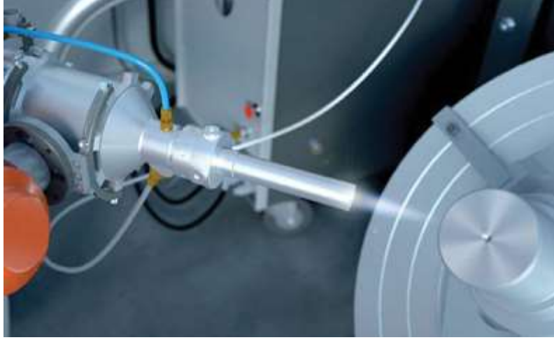
Resim 3.4 Soğuk gaz sprej uygulama resmi [55]
