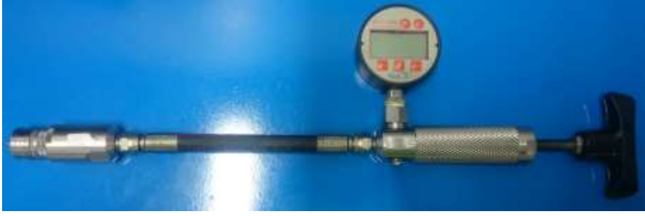
Resim 5.10 ELCOMETER marka pull-off cihaz görüntüsü
