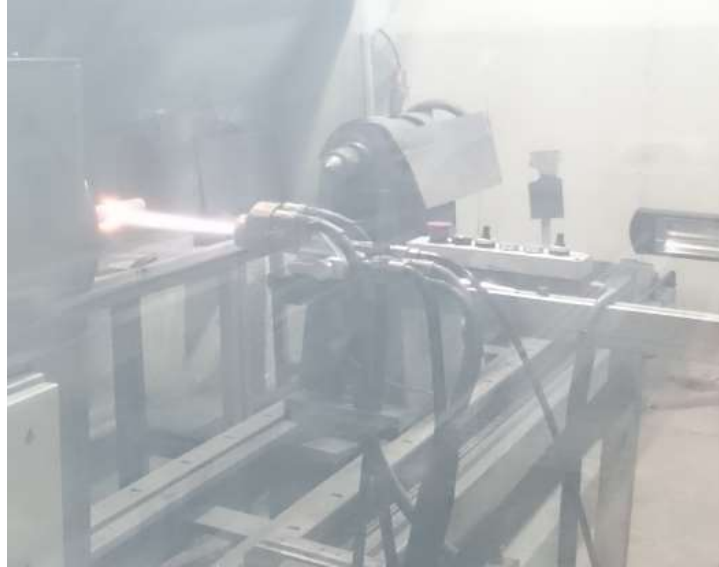
Resim 4.9 HVOF yöntemi ile kaplama işleminin uygulama görüntüsü
