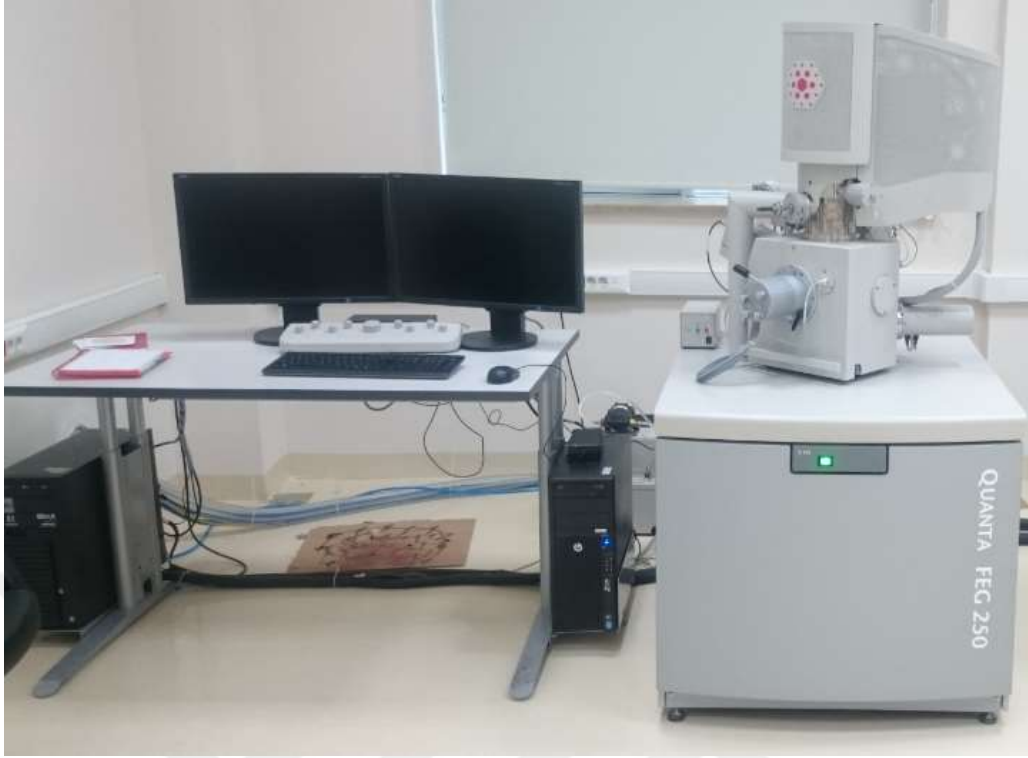
Resim 5.9 QUANTA FEG 250 Taramalı elektron mikroskobu görüntüsü
