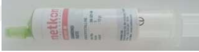
Resim 5.4 Metkon 3 µm elmas aşındırıcılı pasta görüntüsü
