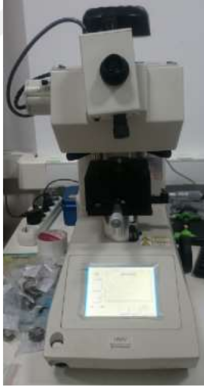
Resim 5.6 HMV-SHIMADZU Vickers mikrosertlik ölçme cihazı
