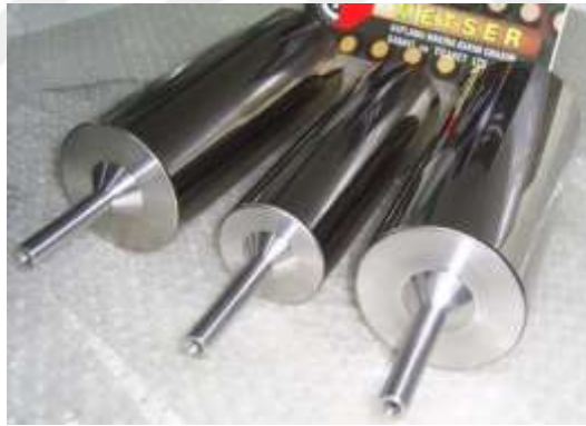
Resim 3.2 HVOF yöntemi ile kaplanmış parça örneği [33]
