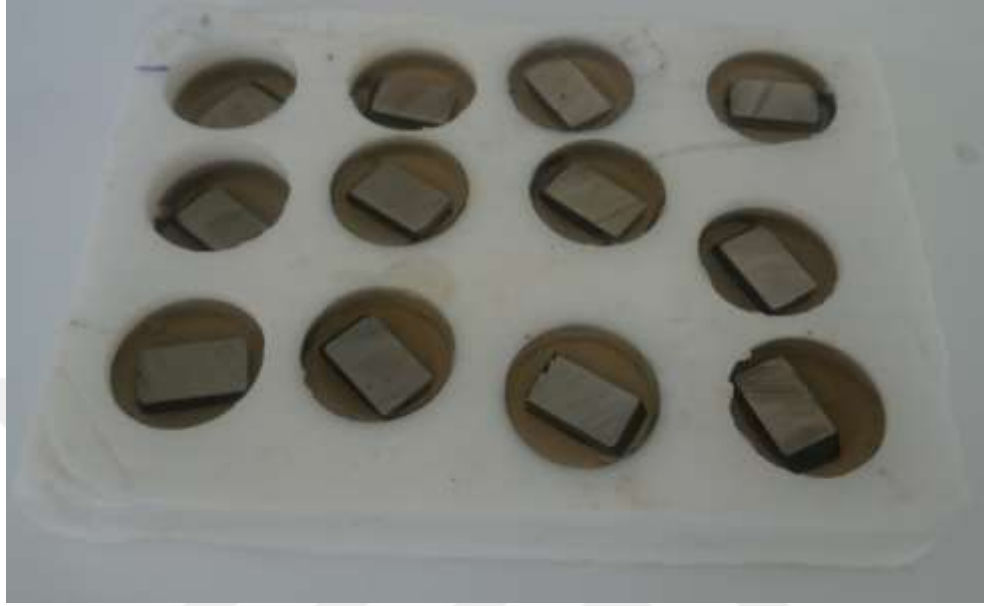
Resim 5.2 Soğuk bakalite alma işlemi görüntüsü
