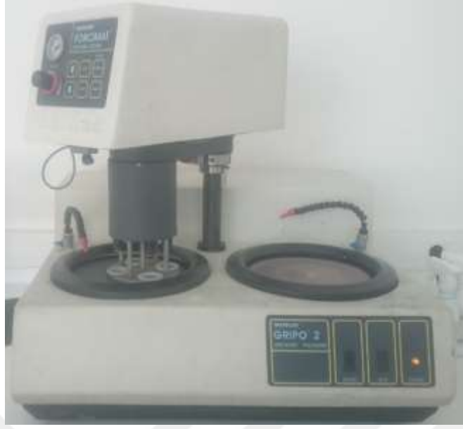
Resim 5.3 Metkon zımparalama ve parlatma makinesi görüntüsü
