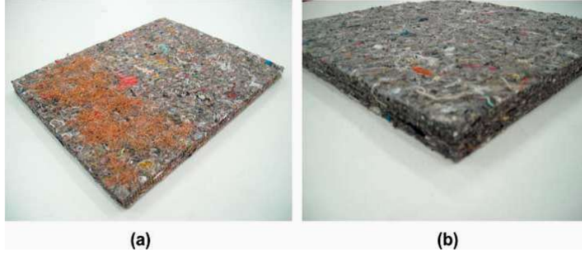
Şekil 2.23 a) Kesilmiş Bakır Tel Serpilmiş Nonwoven Panel b) Çok Katlı Nonwoven Panel [53]
