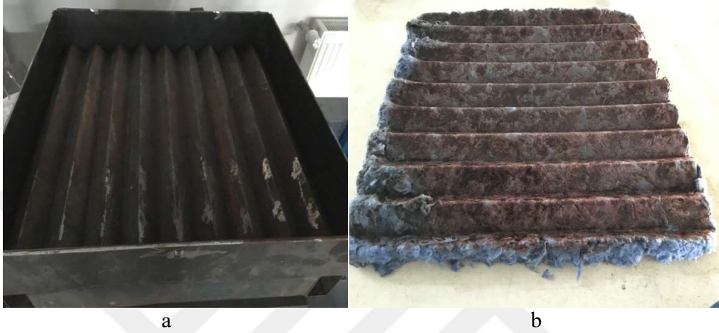
Şekil 3.9 Yüzeyi Bariyerli Olan a) Alt Kalıp b) Kompozit Numune
