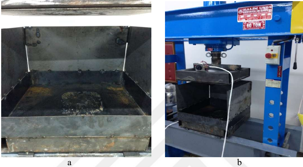
Şekil 3.6 a) Alt Kalıbın Havuz Şeklindeki İç Kısmı b) Pres Düzeneği
