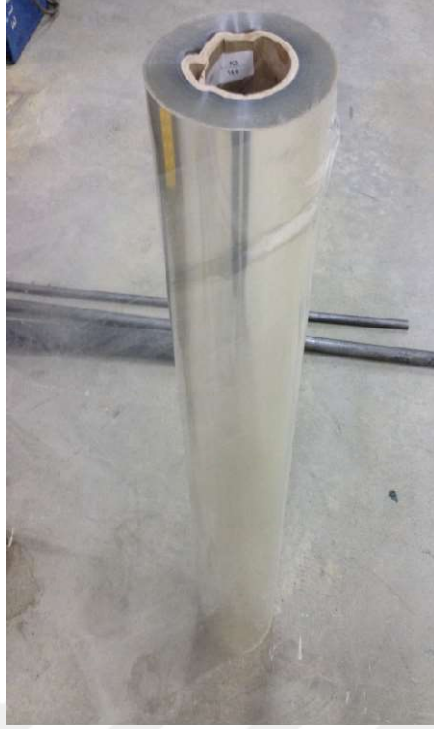
Şekil 3.4 Kalıpların İçerisinde Kullanılan Yapışmaz PET Filmi
