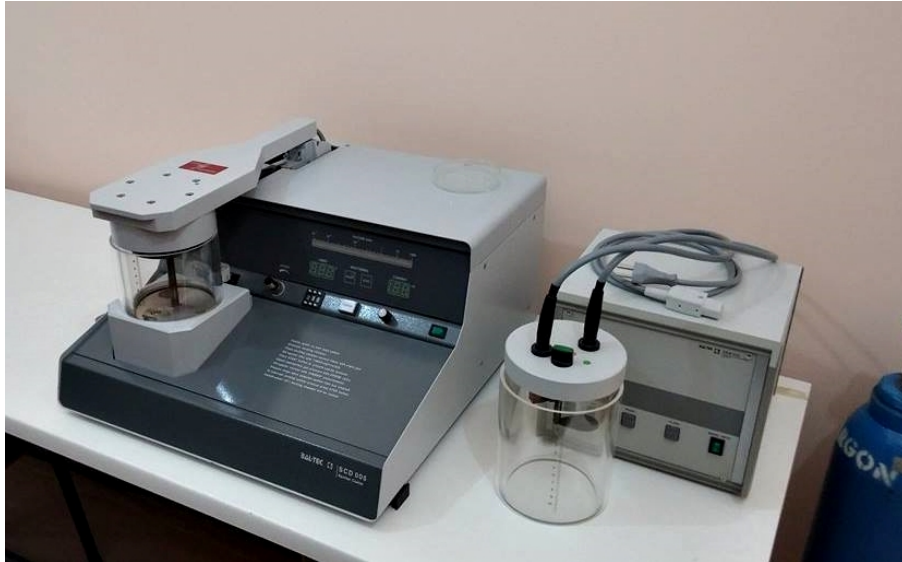
Şekil 3.2. Au-Pd Sputter Coater Kaplama Cihazı
