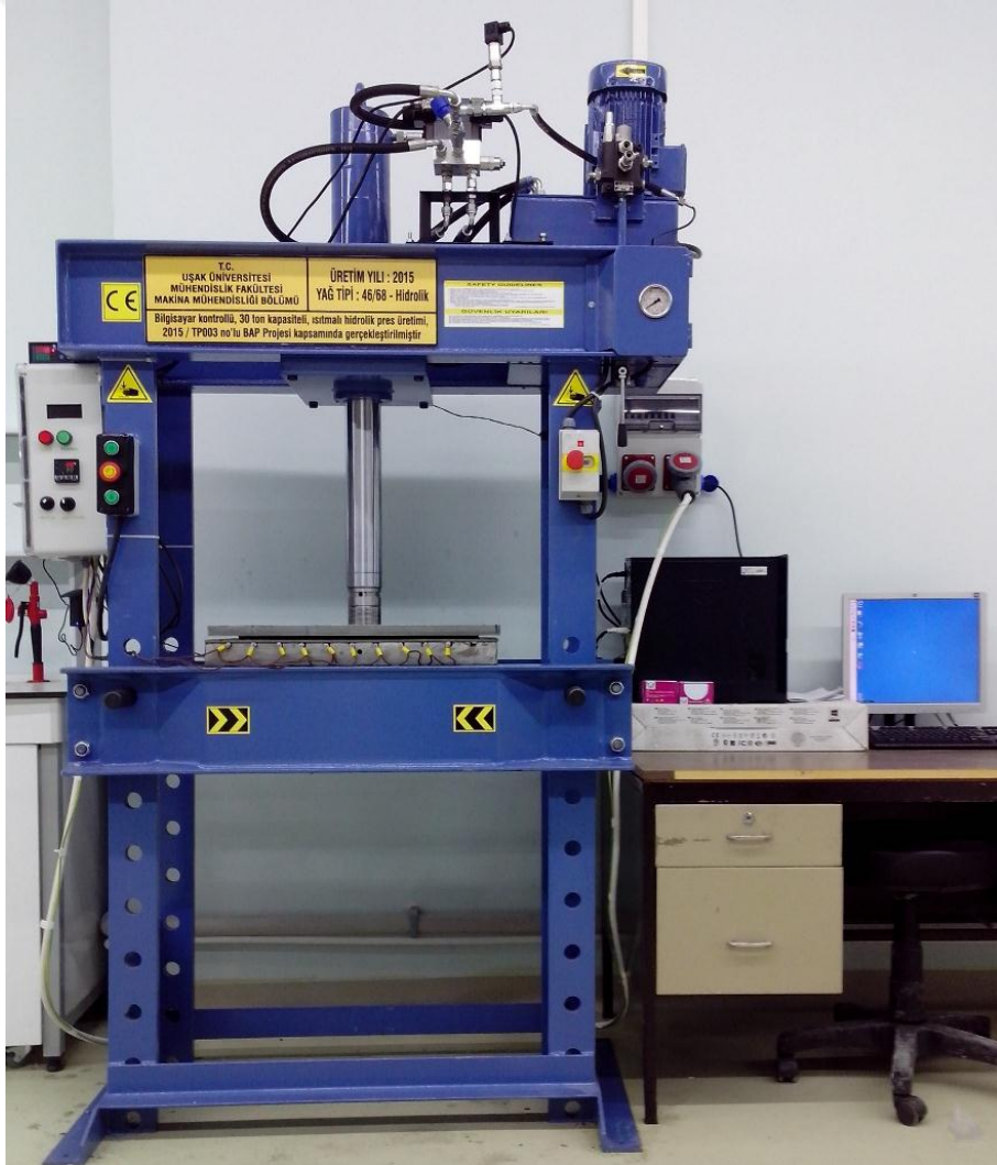
Resim 3.7 Yapısal birleştirmeler üzerinde ön gerilme uygulanmasını sağlayan hidrolik pres makinesi
