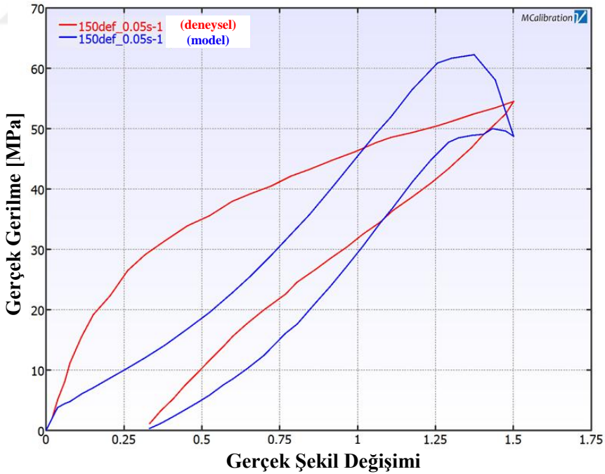
Şekil 6.62 PRF Model: 4 Yeoh ağı ile Bergstrom-Boyce akış malzeme modeline göre %150 deformasyon ve 0,05 \text{ s}^{-1} şekil değiştirme hızı altındaki gerilme-şekil değiştirme davranışlarının deneysel ve analitik olarak karşılaştırılması
