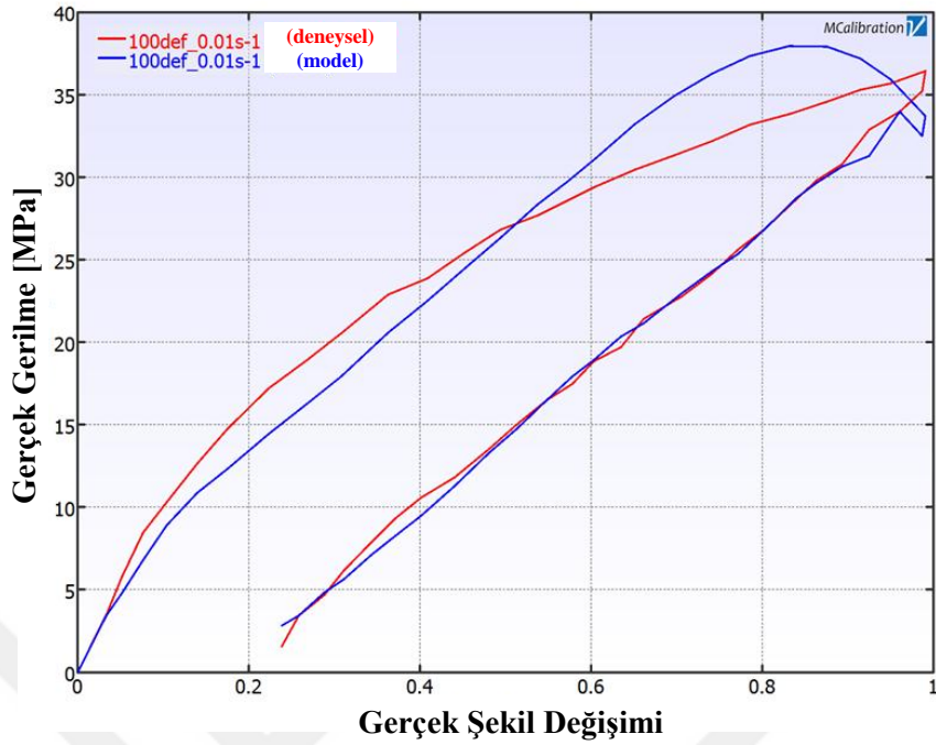
Şekil 6.35 PRF Model: 4 Yeoh ağı ile sinüs hiperbolik akış malzeme modeline göre % 100 deformasyon ve 0,01 \text{ s}^{-1} şekil değiştirme hızı altındaki gerilme-şekil değiştirme davranışlarının deneysel ve analitik olarak karşılaştırılması
