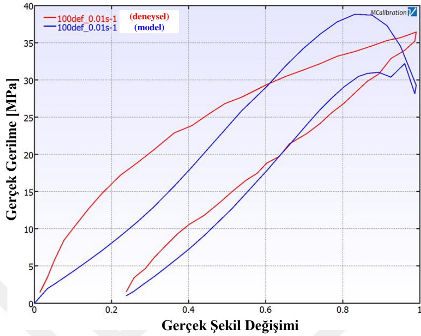
Şekil 6.59 PRF Model: 4 Yeoh ağı ile Bergstrom-Boyce akış malzeme modeline göre %100 deformasyon ve 0,01 \text{ s}^{-1} şekil değiştirme hızı altındaki gerilme-şekil değiştirme davranışlarının deneysel ve analitik olarak karşılaştırılması
