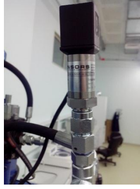
Resim 3.8 Hidrolik sistem üzerinde bağlanan basınç vericisi
