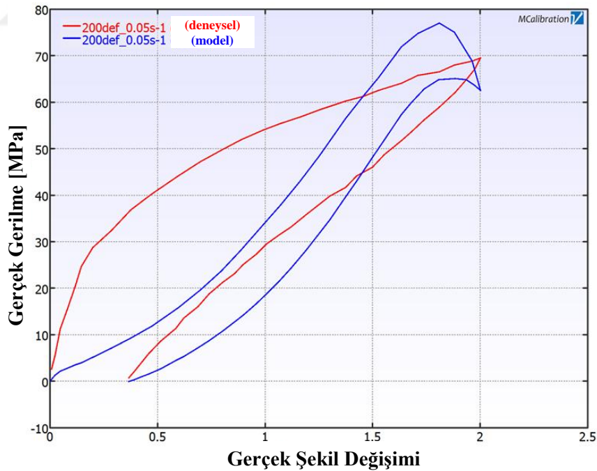
Şekil 6.32 PRF Model: 3 Yeoh ağı ile Bergstrom-Boyce akış malzeme modeline göre %200 deformasyon ve 0,05 s -1 şekil değiştirme hızı altındaki gerilme-şekil değiştirme davranışlarının deneysel ve analitik olarak karşılaştırılması
