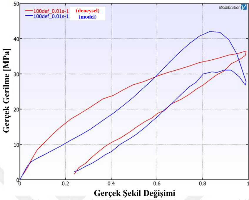
Şekil 6.27 PRF Model: 3 Yeoh ağı ile Bergstrom-Boyce akış malzeme modeline göre %100 deformasyon ve 0,01 \text{ s}^{-1} şekil değiştirme hızı altındaki gerilme-şekil değiştirme davranışlarının deneysel ve analitik olarak karşılaştırılması
