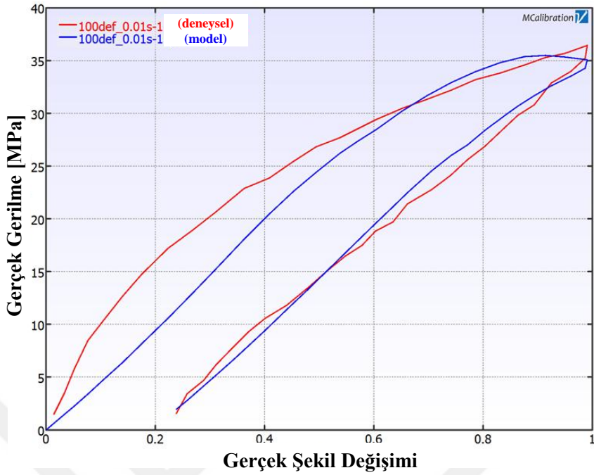
Şekil 6.43 PRF Model: 4 Yeoh ağı ile güç yasası akış malzeme modeline göre % 100 deformasyon ve 0,01 \text{ s}^{-1} şekil değiştirme hızı altındaki gerilme-şekil değiştirme davranışlarının deneysel ve analitik olarak karşılaştırılması
