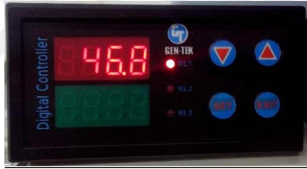
Resim 3.10 Sistemdeki basınç vericisinde elde edilen değeri gösteren dijital indikatör
