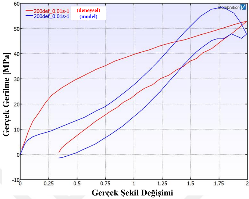
Şekil 6.39 PRF Model: 4 Yeoh ağı ile sinüs hiperbolik akış malzeme modeline göre % 200 deformasyon ve 0,01 \text{ s}^{-1} şekil değiştirme hızı altındaki gerilme-şekil değiştirme davranışlarının deneysel ve analitik olarak karşılaştırılması
