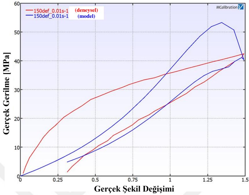
Şekil 6.21 Hiperelastik-Mullins-Yeoh modeline göre % 150 deformasyon ve 0,01 \text{ s}^{-1} şekil değiştirme hızı altındaki gerilme-şekil değiştirme davranışlarının deneysel ve analitik olarak karşılaştırılması
