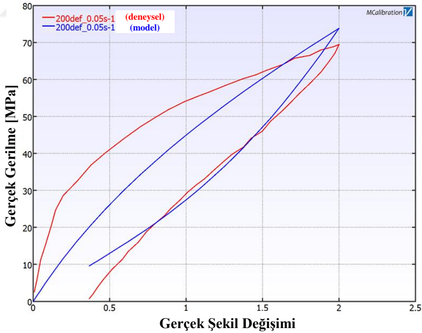
Şekil 6.16 Hiperelastik-Mullins-Ogden modeline göre % 200 deformasyon ve 0,05 \text{ s}^{-1} şekil değiştirme hızı altındaki gerilme-şekil değiştirme davranışlarının deneysel ve analitik olarak karşılaştırılması
