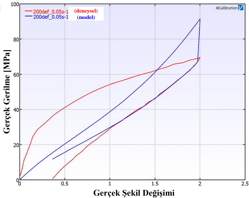
Şekil 6.8 Hiperelastik-Mullins-Mooney-Rivlin malzeme modeline göre % 200 deformasyon ve 0,05 \text{ s}^{-1} şekil değiştirme hızı altındaki gerilme-şekil değiştirme davranışlarının deneysel ve analitik olarak karşılaştırılması
