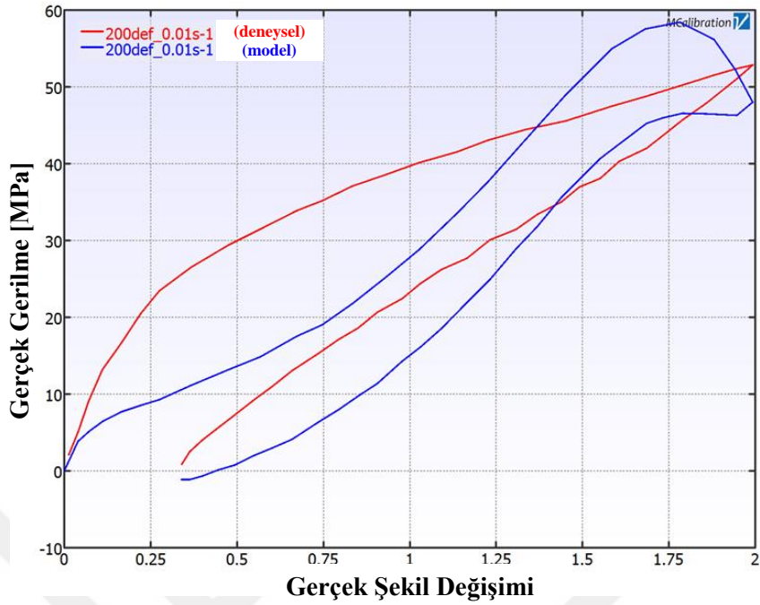
Şekil 6.47 PRF Model: 4 Yeoh ağı ile güç yasası akış malzeme modeline göre % 200 deformasyon ve 0,01 \text{ s}^{-1} şekil değiştirme hızı altındaki gerilme-şekil değiştirme davranışlarının deneysel ve analitik olarak karşılaştırılması
