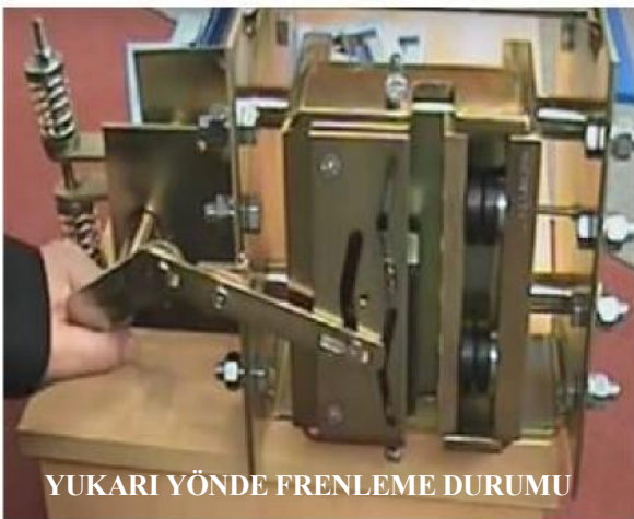
Şekil 3.6 Çift yönlü frenleme sistemi[15]
