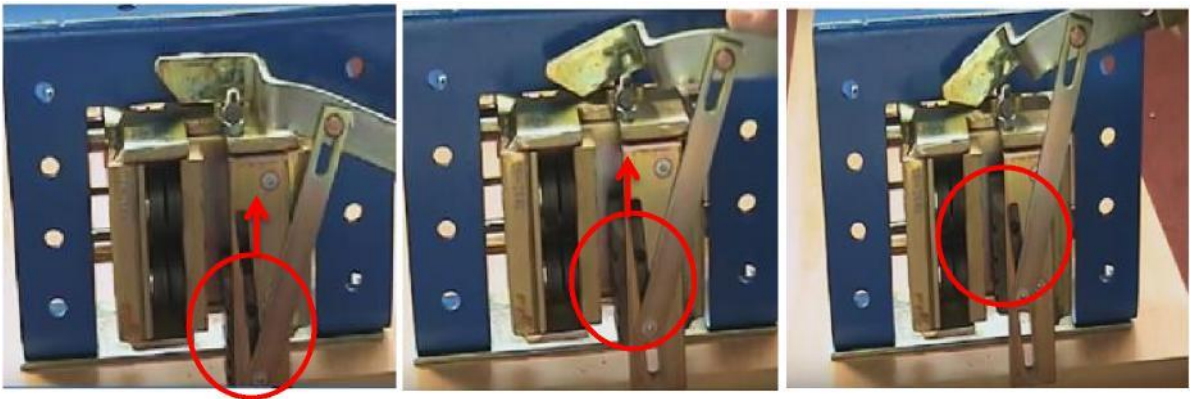
Şekil 3.5 Tek yönlü frenleme sistemi [15]
