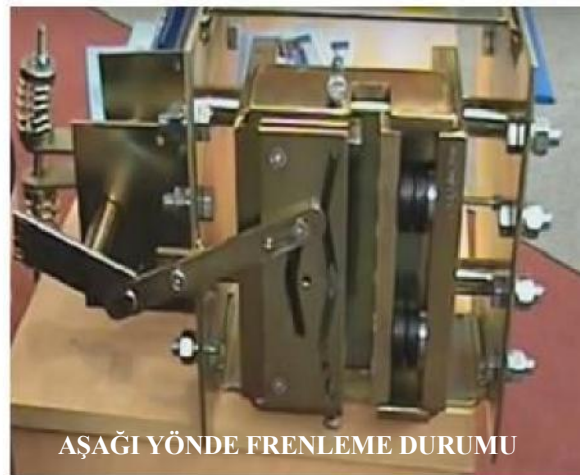
Şekil 3.6 Çift yönlü frenleme sistemi[15]
