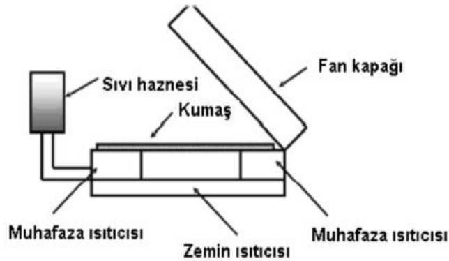
Şekil 3.2. Sıcak levha yöntemiyle ölçüm mekanizması [31]
