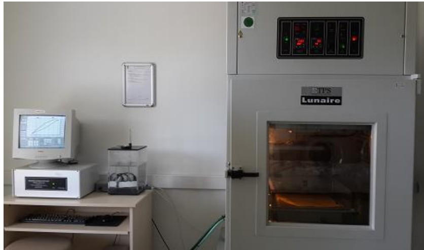
Resim 3.5. Terleme korumalı sıcak plaka test cihazı ve bilgisayar sistemi
