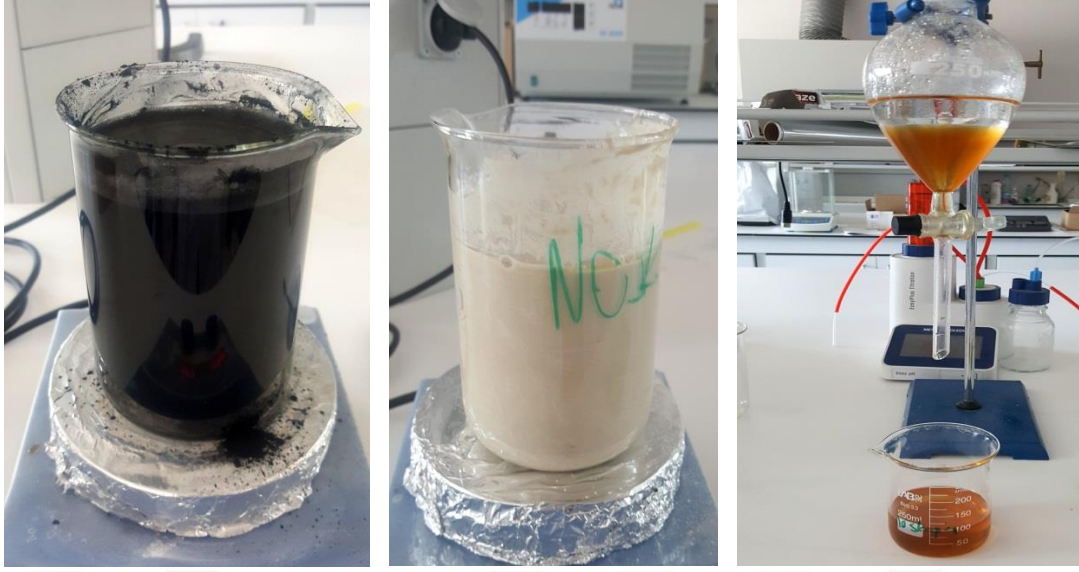
Resim 3.2.2. Ekstraktların ayrılması ve saflaştırılması (a) aktif karbon, (b) diatometoprak, (c) sıvı-sıvı ekstraksiyon
