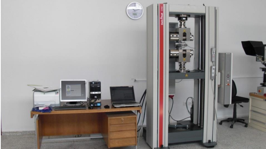
Şekil 3.7. Kompozit malzemelerin analizlerinin yapıldığı basma dayanımı deney cihazı görüntüsü
