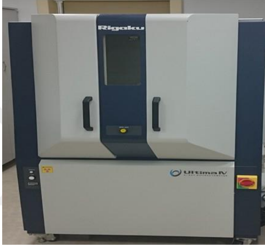
Şekil 3.5. Kompozit malzemelerin analizlerinin yapıldığı X-Işını Difraktometresi XRD deney cihazı görüntüsü
