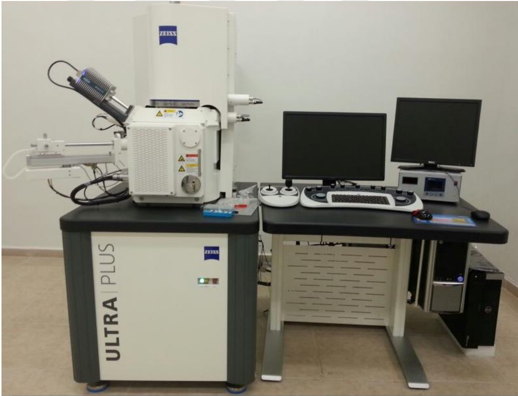
Şekil 3.4. Kompozit malzemelerin analizlerinin yapıldığı EDS donanımlı taramalı elektron mikroskobu (SEM) deney cihazı görüntüsü
