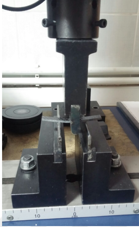
Resim 5.7 Üç nokta eğilme deneyi numunesinin eğilmeye zorlanması
