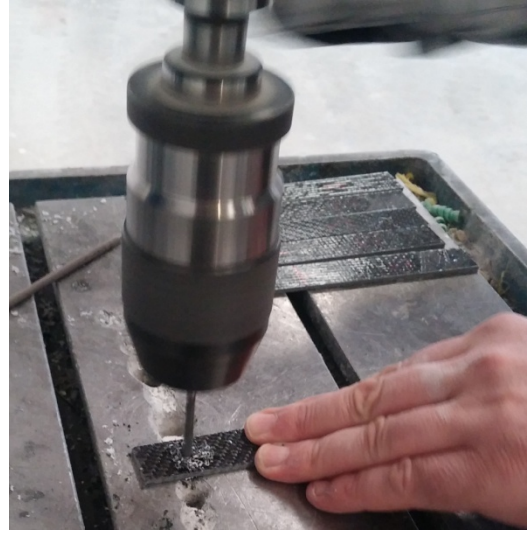
Resim 5.10 4mm'lik matkap ucu ile deliklerin delinmesi işlemi görünüşü a) Cam Elyaf takviyeli kompozit numunenin delinmesi b) Hibrit kompozit malzemenin delinmesi
