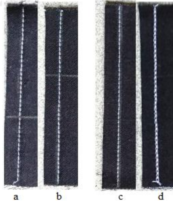
Şekil 1.10. Poliester özlü poliester dikiş ipliği ile oluşturulan dikişler a. Düz dikişin önden görünümü b. Düz dikişin arkadan görünümü c. Zincir dikişin önden görünümü d. Zincir dikişin arkadan görünümü
