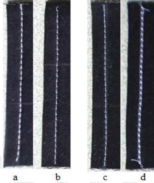
Şekil 1.9. Elastan özlü poliester dikiş ipliği ile oluşturulan dikişler a. Düz dikişin önden görünümü b. Düz dikişin arkadan görünümü c. Zincir dikişin önden görünümü d. Zincir dikişin arkadan görünümü
