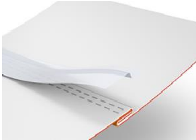
Resim 2.36. Konvansiyonel dikiş üzerine kaynak bant uygulaması gösterimi [71]
