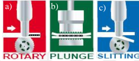
Resim 1.4. Farklı modlarda ultrasonik dikiş işlemi a) Devamlı mod b) Kesikli mod c) Kesme modu [9]
