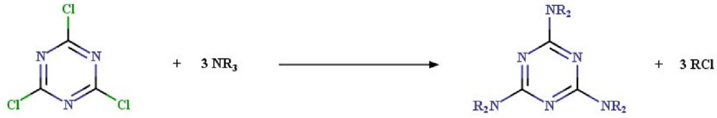
Şekil 1.62 Siyanürik klorür kullanılarak tersiyer aminlerden melamin türevleri oluşturma reaksiyonu
