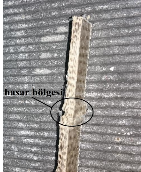
Resim 5.6 ASTM 3410 – 87 standart numaralı basma numunelerinin deney sonrası hasar görüntüleri
