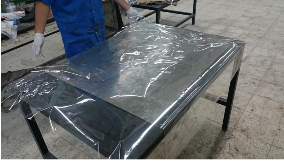
Resim 4.8 Metal sac levha üzerine mikro filmin serilmesi
