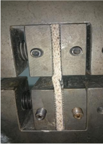
Resim 5.6 ASTM 3410 – 87 standart numaralı basma numunelerinin deney sonrası hasar görüntüleri
