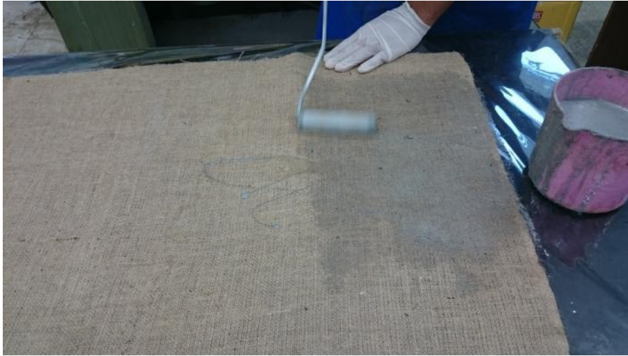
Resim 4.9 Matris karışımının jüt kumaşa absorbe edilmesi
