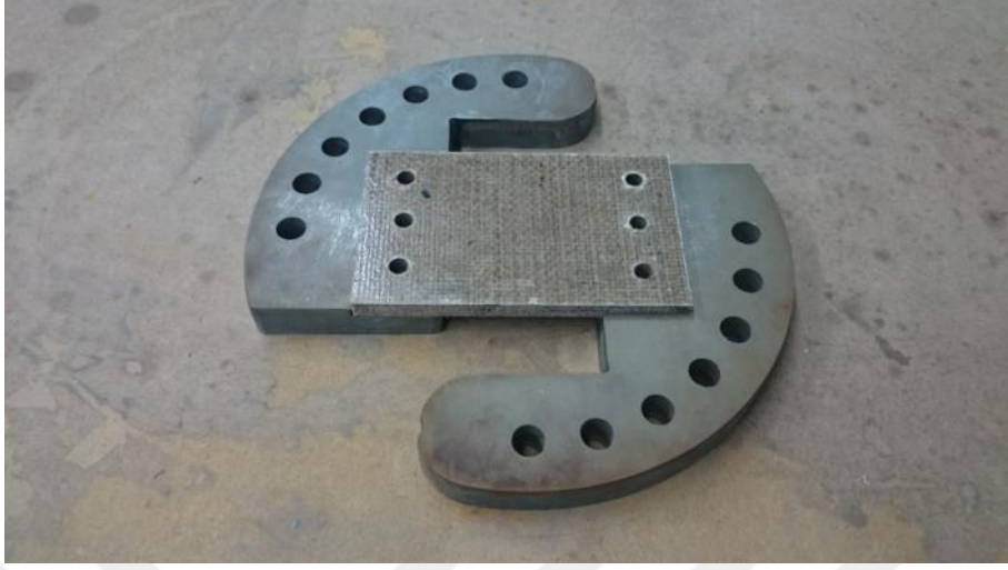
Resim 4.16 Arcan test aparatına CTS numunesinin bađlanması
