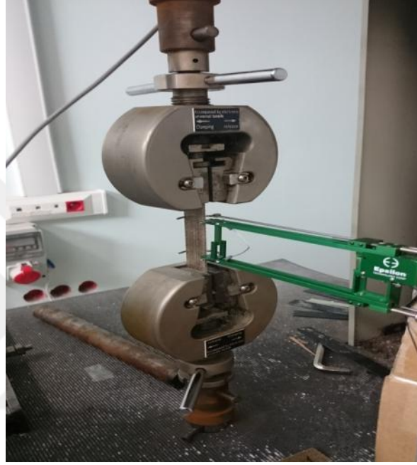
Resim 5.2 Ekstansiyometrenin test numunesine bağlanması
