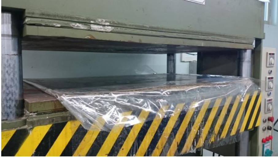
Resim 4.11 Kompozit levhanın hidrolik prese yerleştirilmesi
