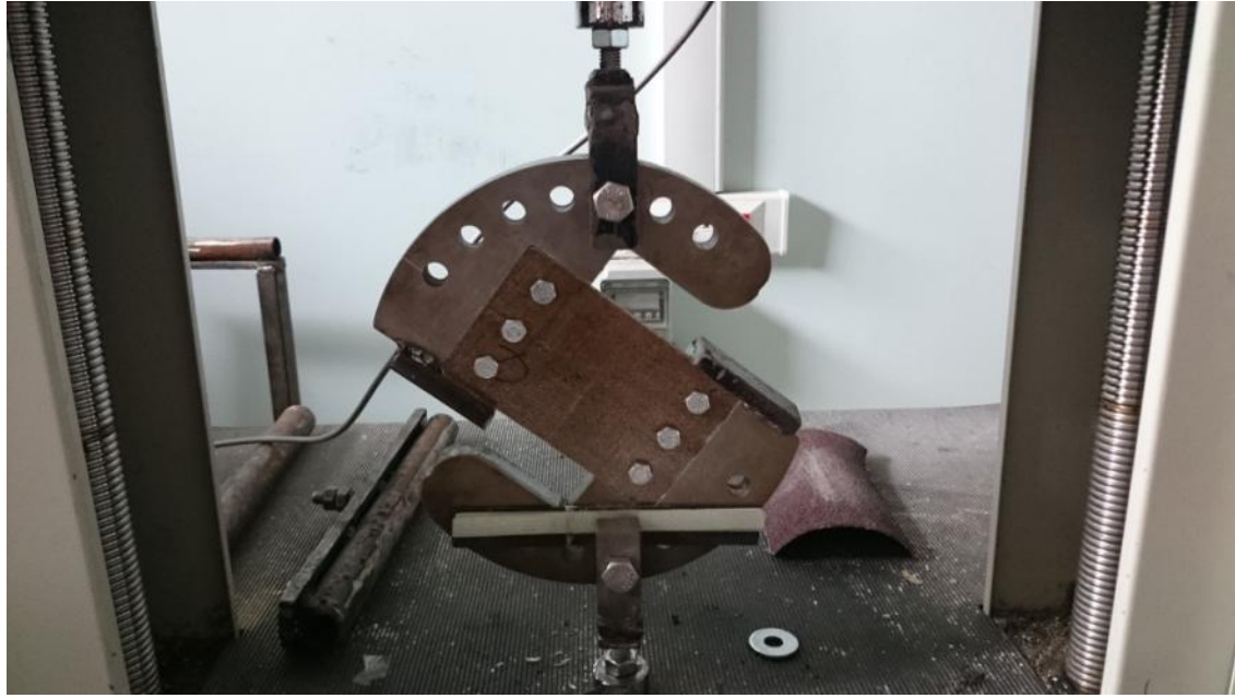
Resim 5.8 CTS numunesinin arcan test aparatına olan bağlantısı
